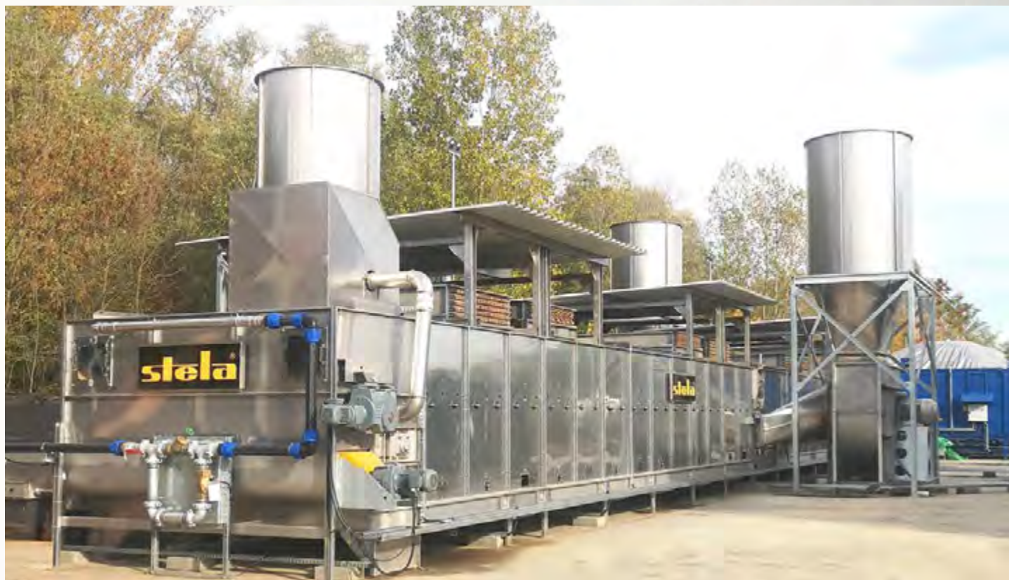
项目地: Biopellets Sp.z o.o., 波兰 | 型号: BTL 1/3000-27 | 安装年份: 2020 干燥物料: 木屑 | 出料能力: 约5.0吨/小时 | 降水区间: 50% - 10%湿度
