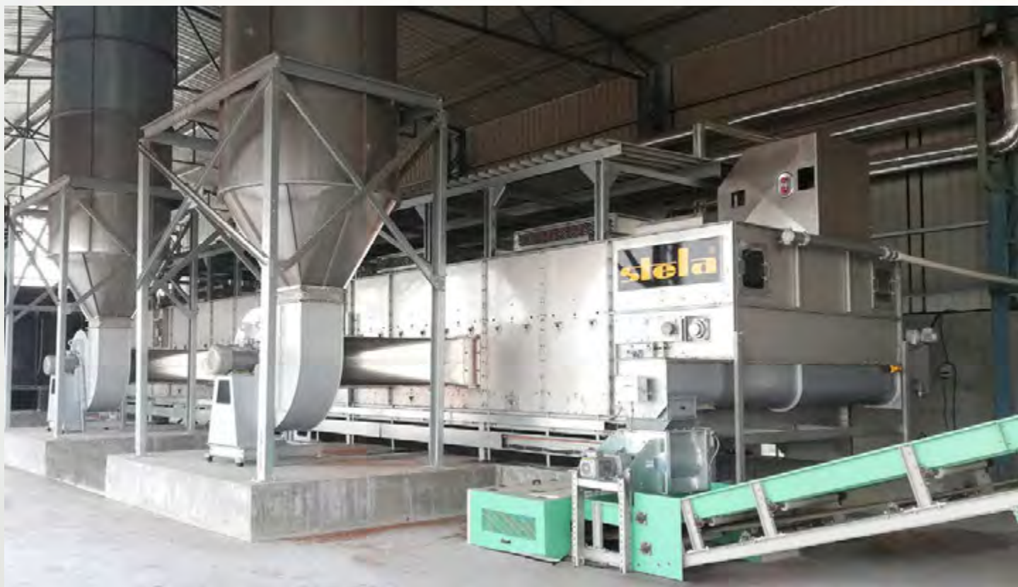
项目地：Remmy Substrates, 印度 | 型号：BTLU 1/3000-15 | 安装年份：2018 干燥物料：椰糠 | 出料能力：约1.25吨/小时 | 降水区间：60% - 20%湿度
