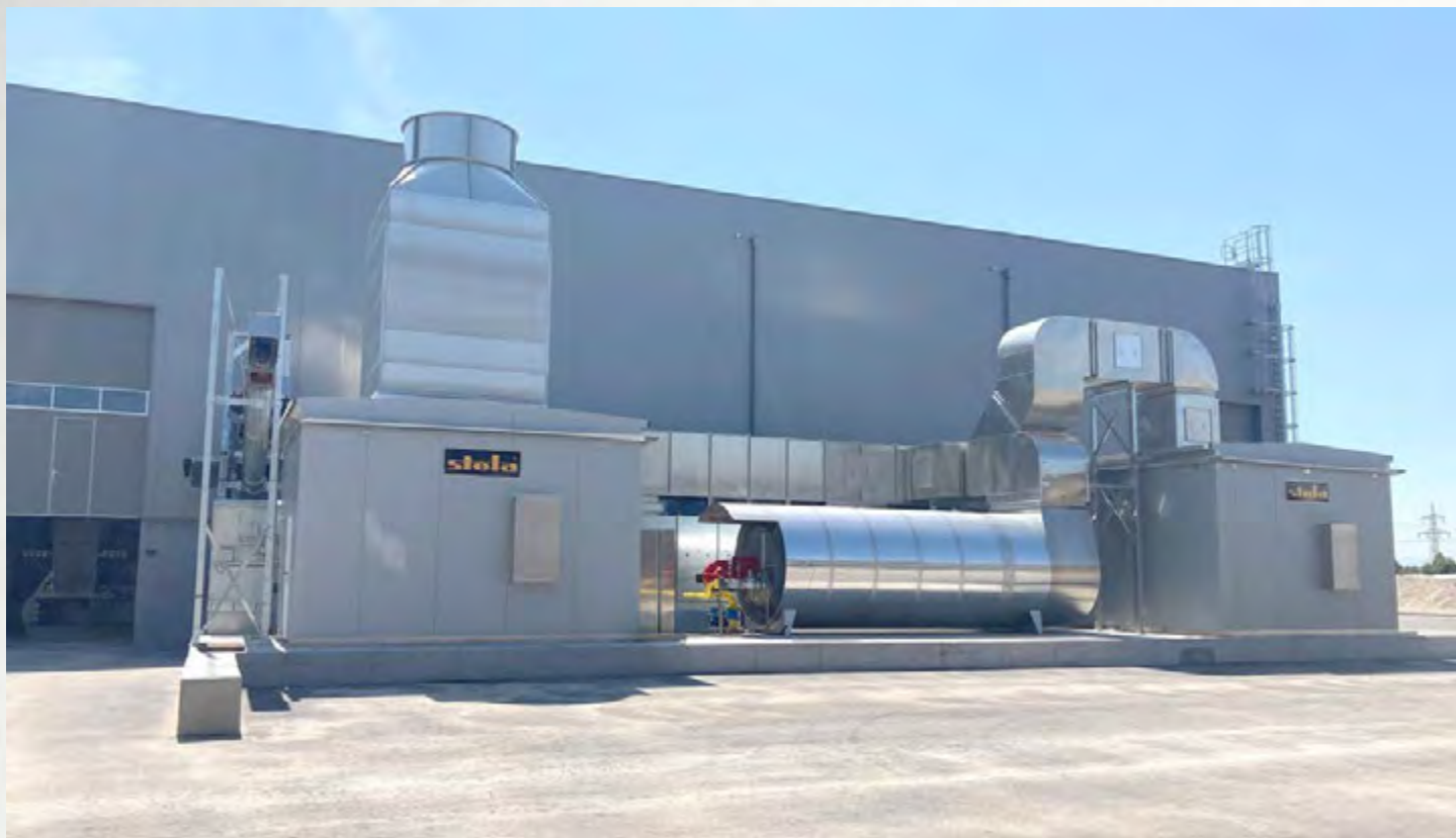
项目地：GWV Wertstoffvermarktung, 奥地利 | 型号：BTLU 1/3000-25 | 安装年份：2022 干燥物料：纸浆 | 出料能力：约7.0吨/小时 | 降水区间：58% - 30%湿度
