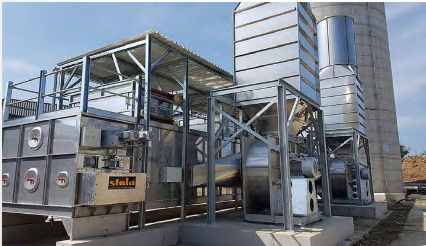
项目地：Aprobois, 法国 | 型号：BTL 1/3000-16 | 安装年份：2017 干燥物料：木屑 | 出料能力：约3.1吨/小时 | 降水区间：50% - 10%湿度
