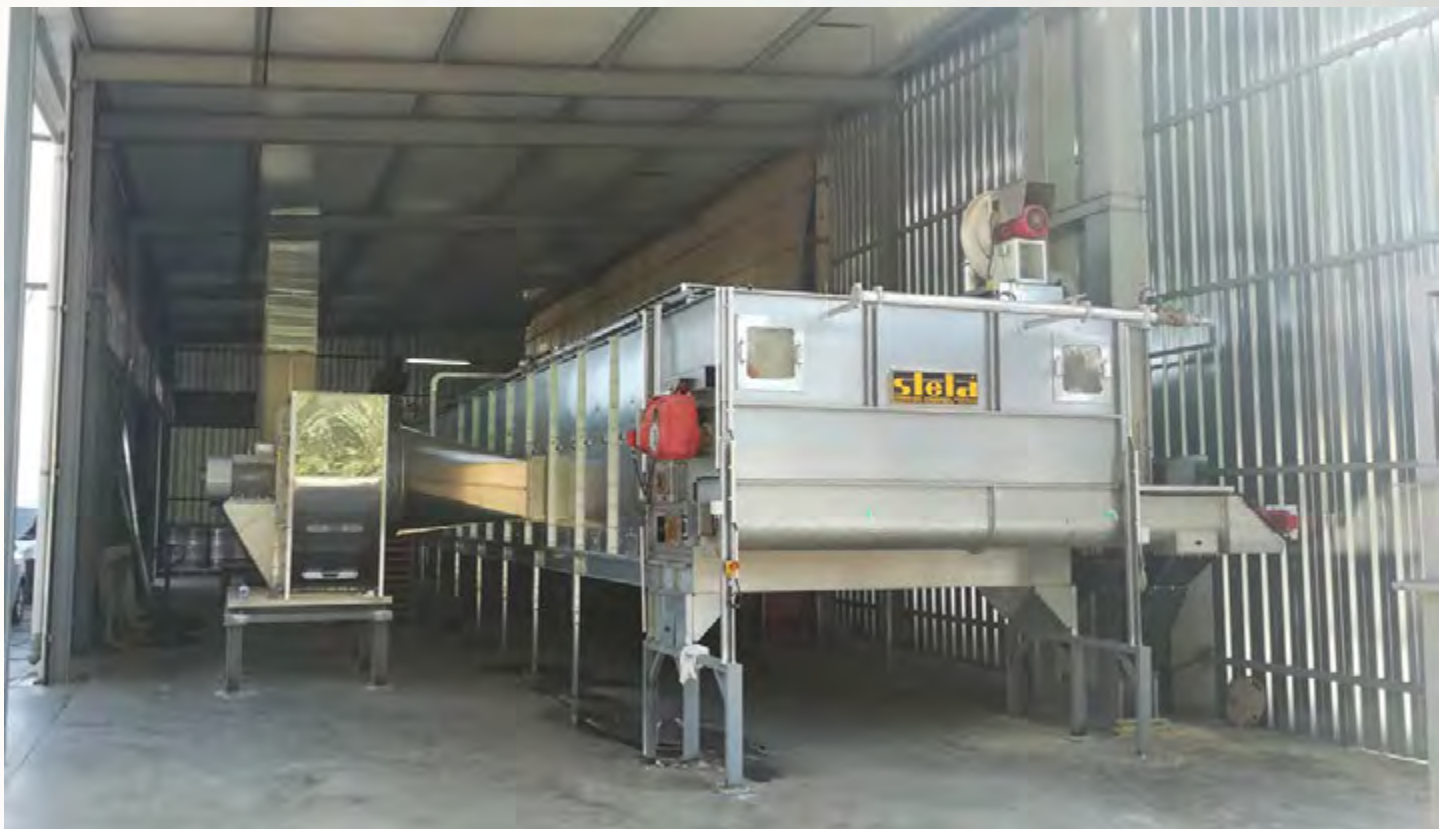
项目地：Pallets J. Martorell S.A., 西班牙 | 型号：扩展至BTL 1/3000-19 | 安装年份：2018 干燥物料：木屑 | 出料能力：约3.12吨/小时 | 降水区间：50% - 10%湿度
