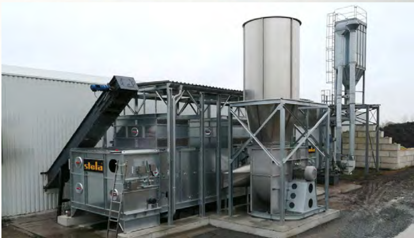
项目地：Bois Factory 36, 法国 | 型号：BTL 1/3000-10 | 安装年份：2019 干燥物料：木片 | 出料能力：约1.65吨/小时 | 降水区间：50% - 12%湿度
