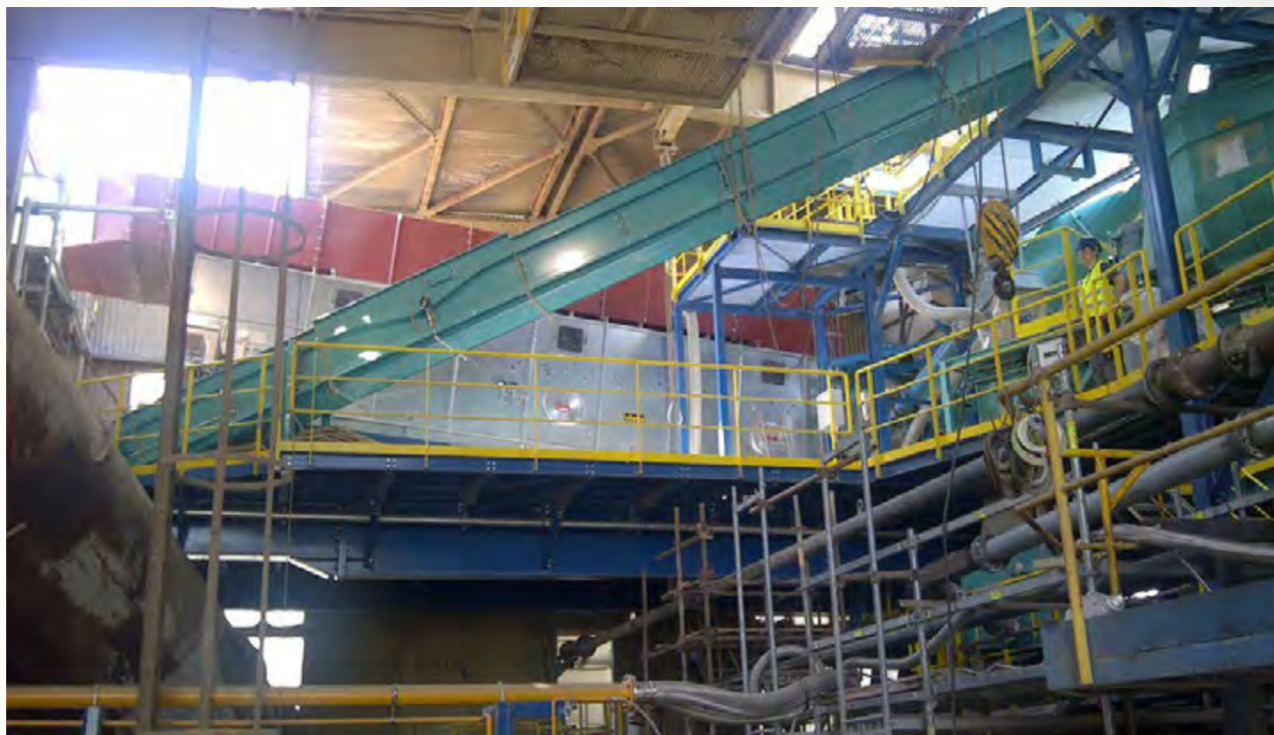
项目地：拉法基, 捷克 | 型号：BTL 1/3000-8 | 安装年份：2014 干燥物料：SSW固废垃圾 | 出料能力：约5.7吨/小时 | 降水区间：26% - 10%湿度
