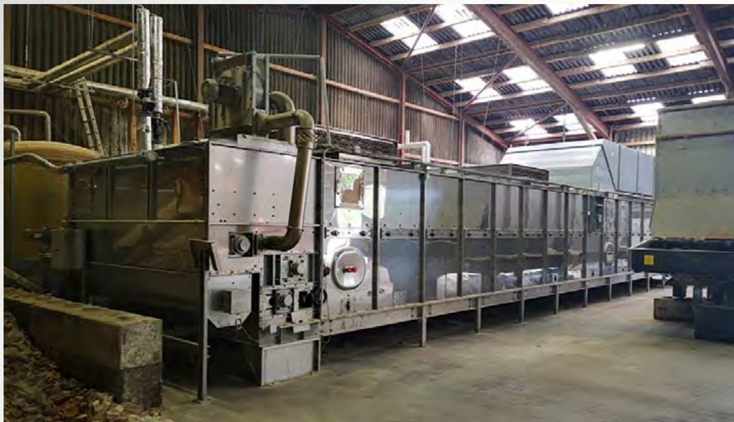
项目地：Hüntelmann Agrar, 德国 | 型号：BTL 1/3000-16 | 安装年份：2019 干燥物料：面包渣 | 出料能力：约4.8吨/小时 | 降水区间：35% - 12%湿度
