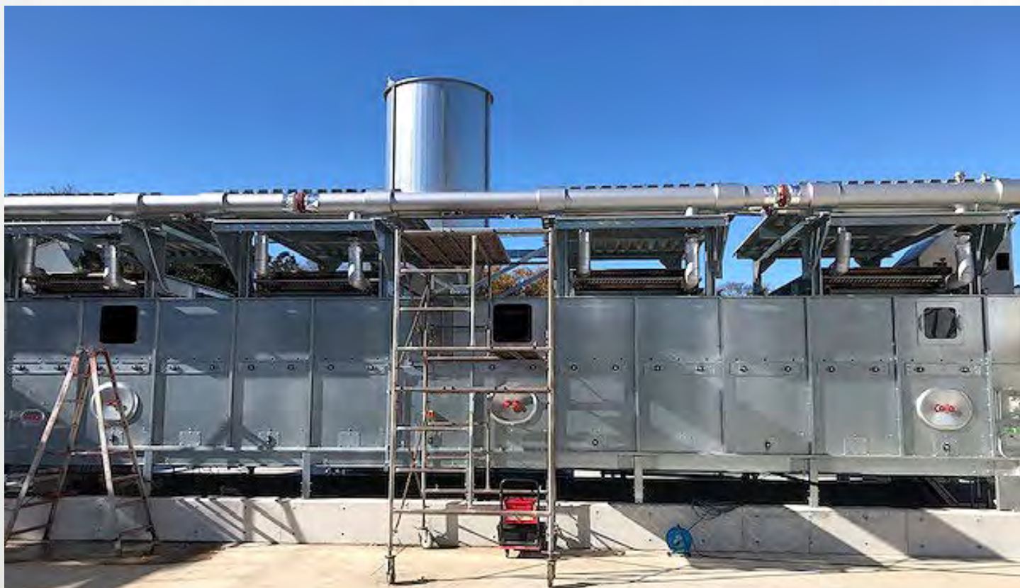
项目地：Masashi Ishii, 日本 | 型号：BTL 1/3000-12 | 安装年份：2020 干燥物料：木片 | 出料能力：约1.71吨/小时 | 降水区间：50% - 15%湿度
