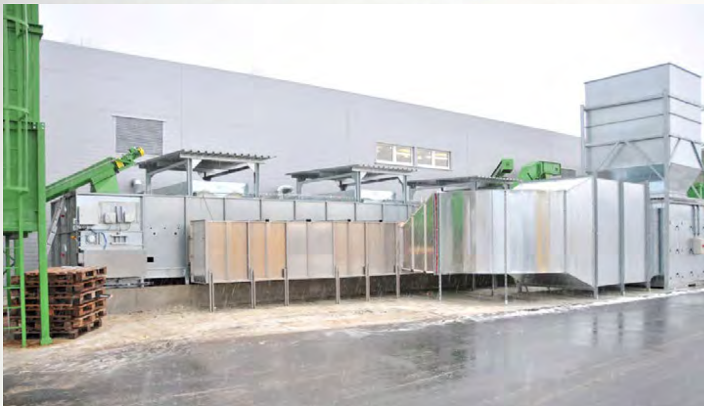
项目地: Alpine Energie, 捷克 | 型号: BTL 1/3000-14 | 安装年份: 2012 干燥物料: 木屑 | 出料能力: 约2.0吨/小时 | 降水区间: 50% -10%湿度
