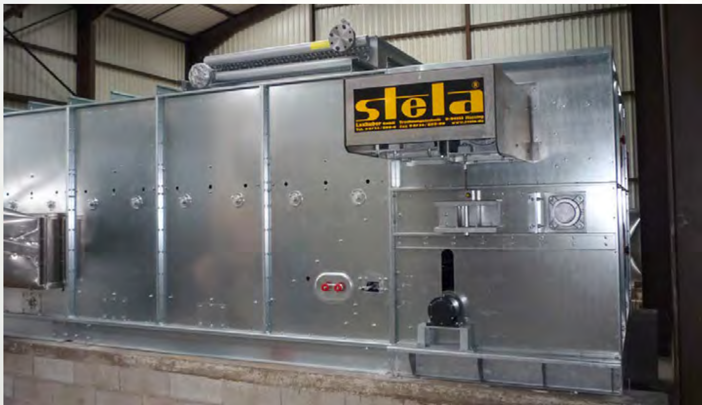
项目地：Enerphyt, 法国 | 型号：BTL 1/3000-9 | 安装年份：2013 干燥物料：木屑 | 出料能力：约2.0吨/小时 | 降水区间：45% - 10%湿度
