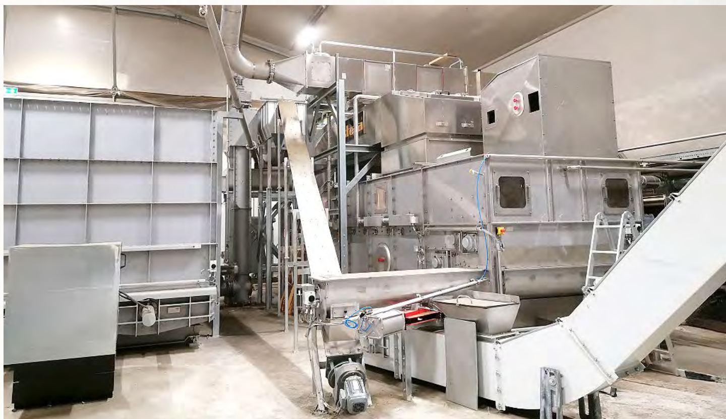
项目地：Ämmässuo waste management center, 芬兰 | 型号：BTLU 1/2000-6 | 安装年份：2016 干燥物料：市政污泥、木屑 | 出料能力：约0.19吨/小时 | 降水区间：69% - 10%湿度
