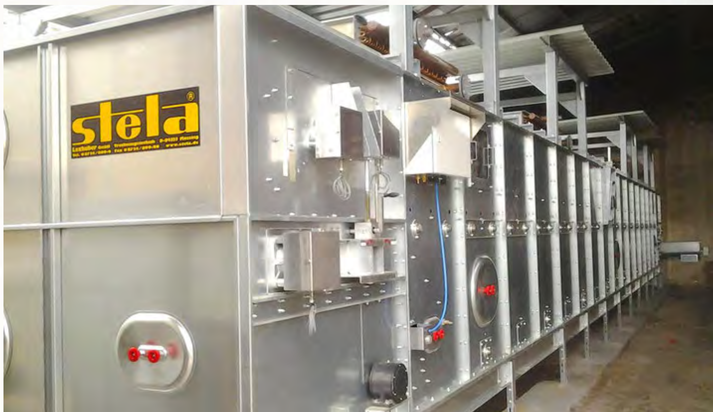
项目地：POLTAREX Polskie Drewno Sp.z.o.o., 波兰 | 型号：BTL 1/3000-16 | 安装年份：2015 干燥物料：木屑 | 出料能力：约2.5吨/小时 | 降水区间：50% - 10%湿度
