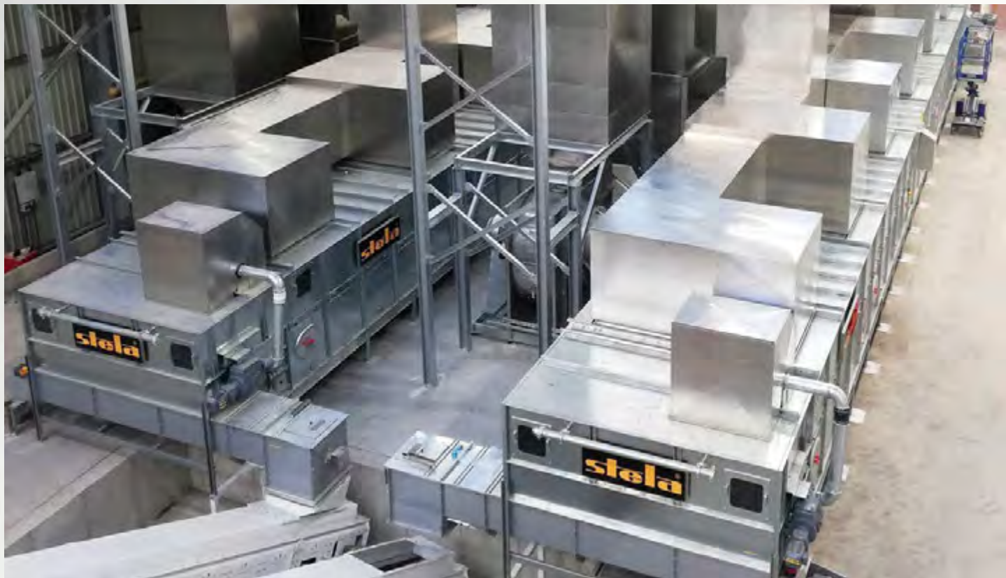
项目地：AV Dawson, 英国 | 型号：2x BTL 1/3000-22 | 安装年份：2021 干燥物料：SRF替代燃料 | 出料能力：约36.0吨/小时 | 降水区间：20% - 10湿度
