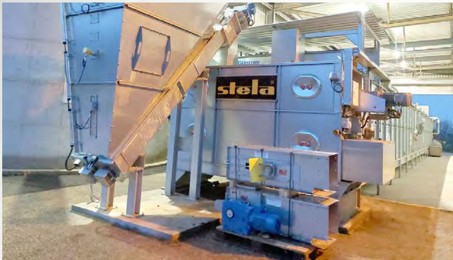
项目地：Bioenergieverband Amstetten, 奥地利 | 型号：BTL 1/3000-26 | 安装年份：2022 干燥物料：木屑 | 出料能力：约1.6吨/小时 | 降水区间：50% - 10%湿度
