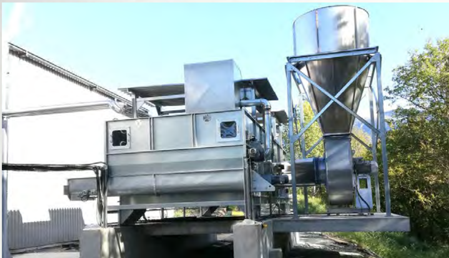
项目地：Granules de la Valserine, 法国 | 型号：BTL 1/3000-6 | 安装年份：2019 干燥物料：木屑 | 出料能力：约1.0吨/小时 | 降水区间：50% - 10%湿度
