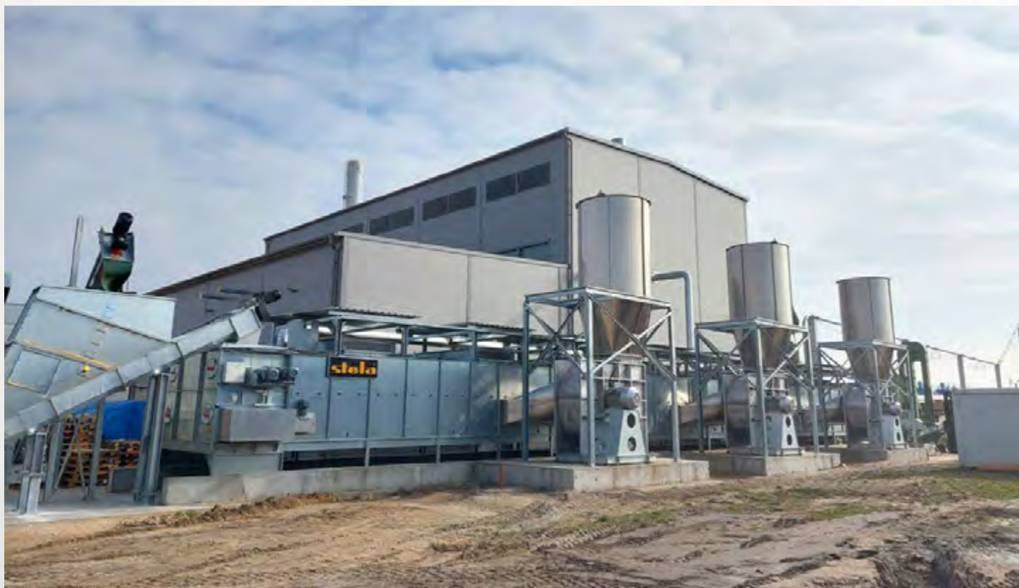
项目地：MMJ Sp. z.o.o., 波兰 | 型号：BTL 1/3000-32 | 安装年份：2022 干燥物料：木屑 | 出料能力：约4.5吨/小时 | 降水区间：50% - 10%湿度
