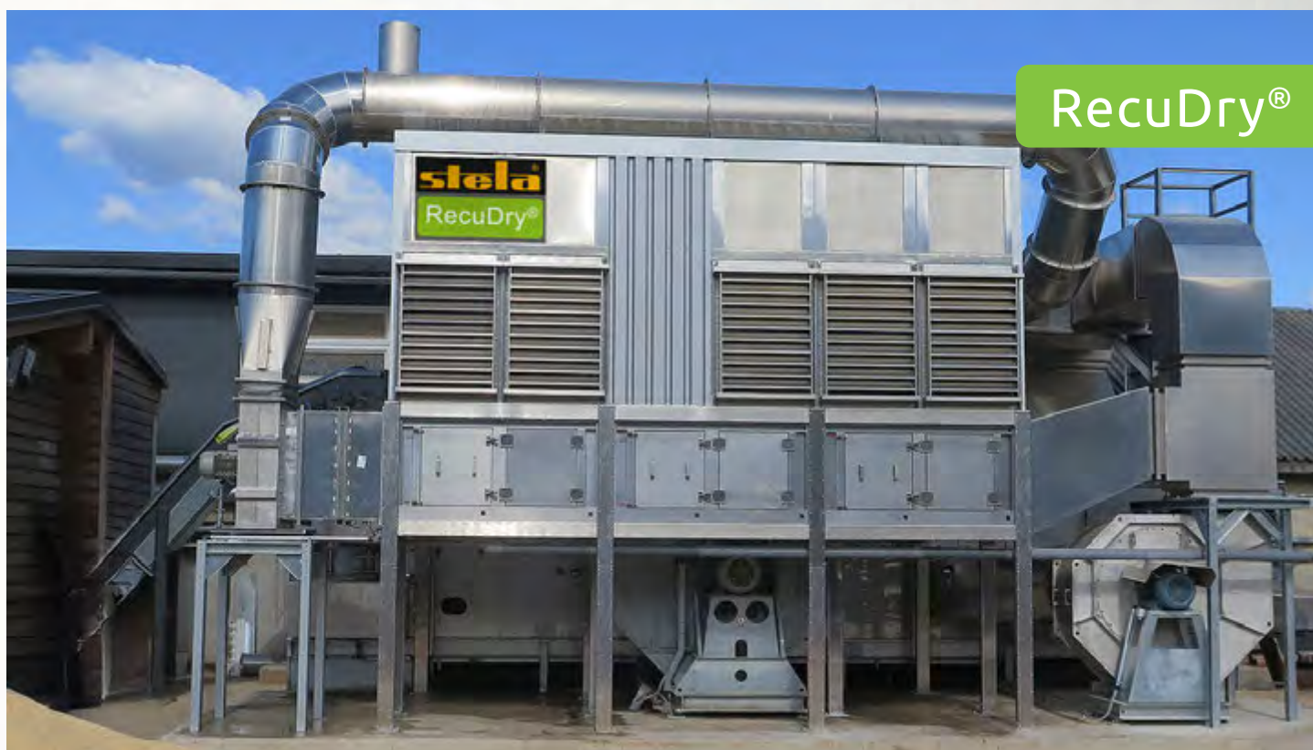
项目地：Holz Bauer KG, 奥地利 | 型号：BTLU RecuDry 1/3000-9 | 安装年份：2019 干燥物料：木屑 | 出料能力：约1.0吨/小时 | 降水区间：50% - 10%湿度
