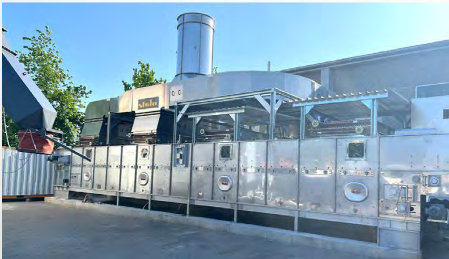
项目地：Span Service Holzlogistik GmbH, 德国 | 型号：BTLU 1/3000-14 | 安装年份：2023 干燥物料：木屑 | 出料能力：约3.3吨/小时 | 降水区间：29% - 10%湿度
