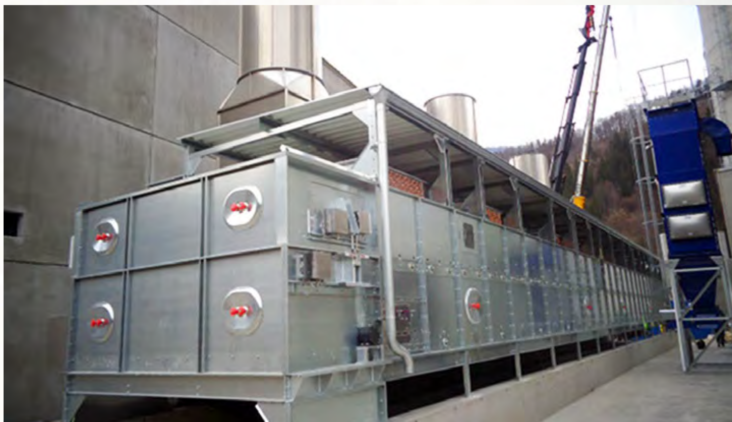
项目地：Andreas Wiesbauer, 奥地利 | 型号：BTL 1/3000-27 | 安装年份：2021 干燥物料：木屑 | 出料能力：约5.0吨/小时 | 降水区间：50% - 10 %湿度
