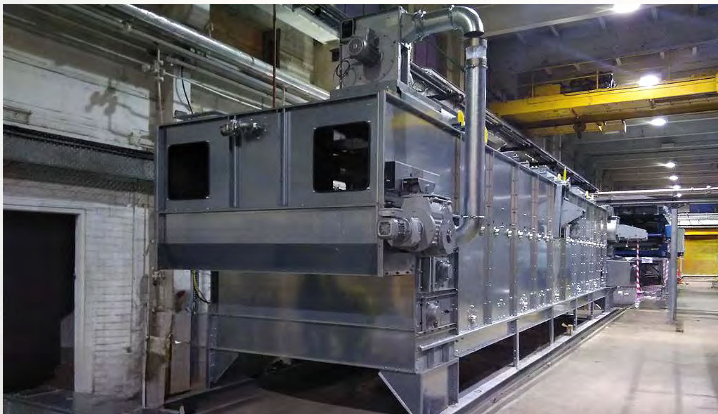
项目地：Sembcorp Utilities UK, 英国 | 型号：BTL 1/2000-10 | 安装年份：2018 干燥物料：硬木浆 | 出料能力：约0.86吨/小时 | 降水区间：50% - 5%湿度
