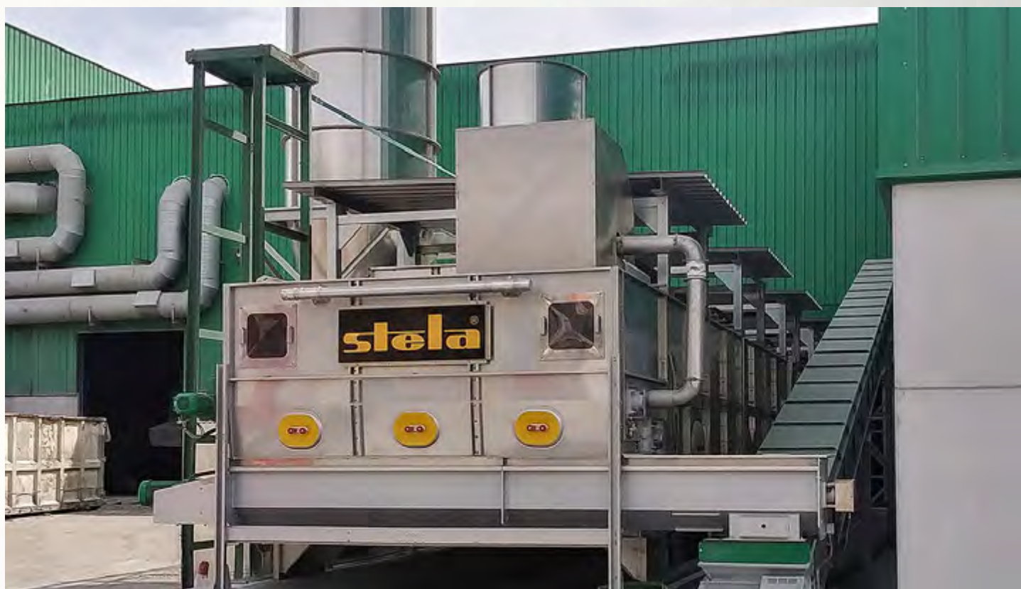
项目地：FCC Centro de tratamiento de residuos las marinas, 西班牙 | 型号：BTL 1/3000-18 | 安装年份：2021 干燥物料：CDR垃圾燃料 | 出料能力：约3.7吨/小时 | 降水区间：42.5% - 15%湿度
