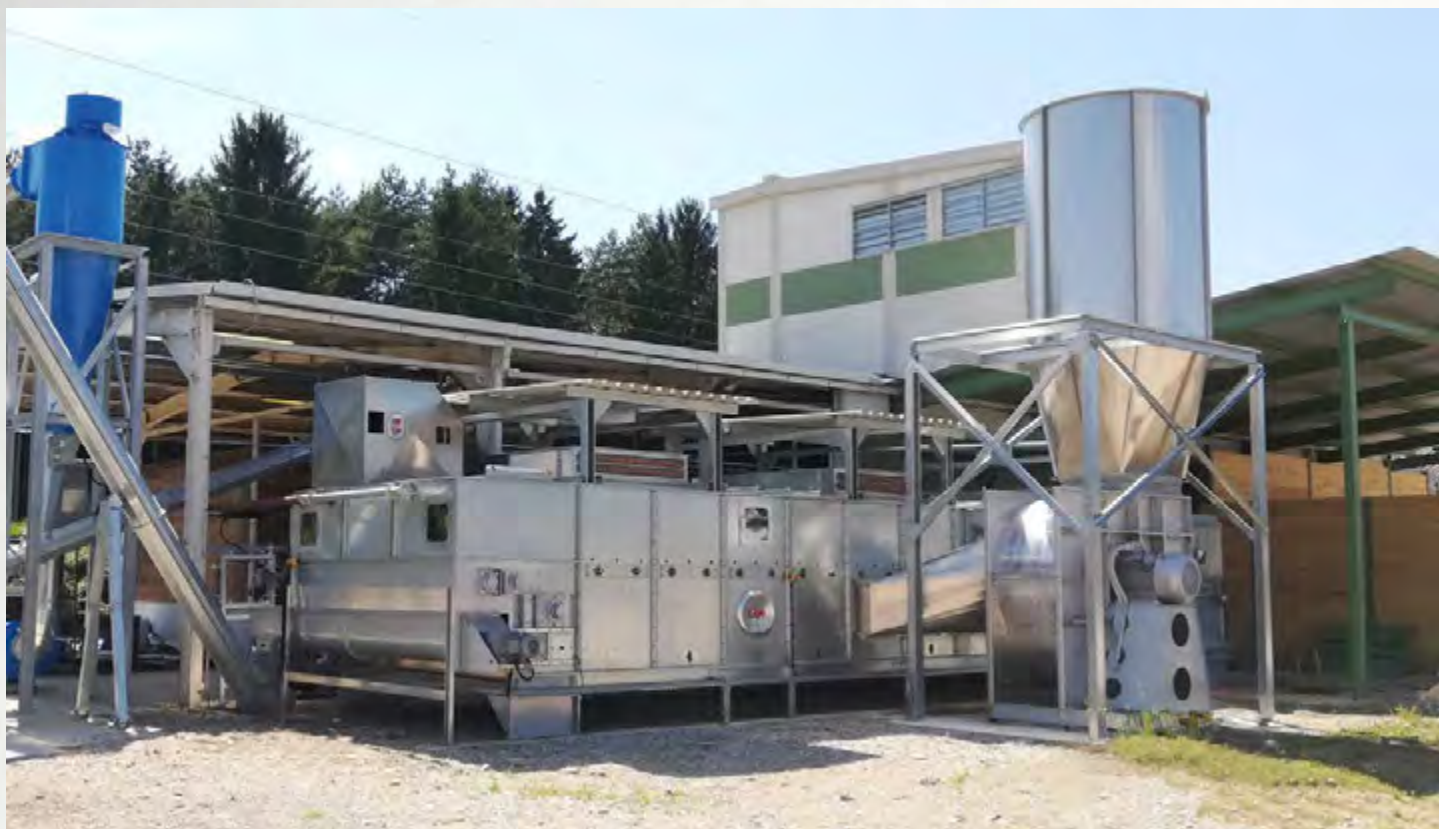
项目地：Lesoteka IP, 斯洛文尼亚 | 型号：BTL 1/3000-11 | 安装年份：2018 干燥物料：木屑 | 出料能力：约1.5吨/小时 | 降水区间：50% - 10%湿度
