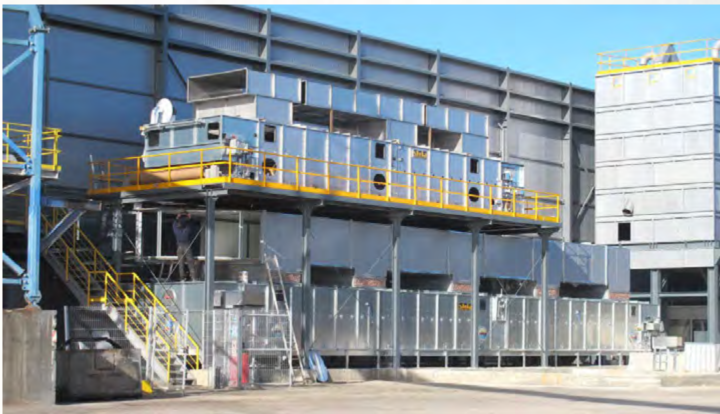
项目地：Palser S.A., 葡萄牙 | 型号：BTL 1/3000-12 (上层) BTL 1/3000-22 (下层) | 安装年份：2013 | 干燥物料：木屑 上层出料能力：约11.5吨/小时 | 降水区间：45% - 38%湿度 | 下层出料能力：约7.8吨/小时 | 降水区间：38% - 10%湿度
