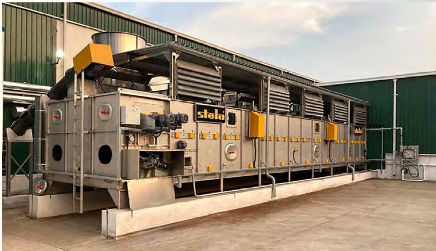
项目地: Biogrow Substrates, 印度 | 型号: BTL 1/3000-15 | 安装年份: 2022 干燥物料: 椰糠泥炭 | 出料能力: 约1.25吨/小时 | 降水区间: 60% - <20%湿度
