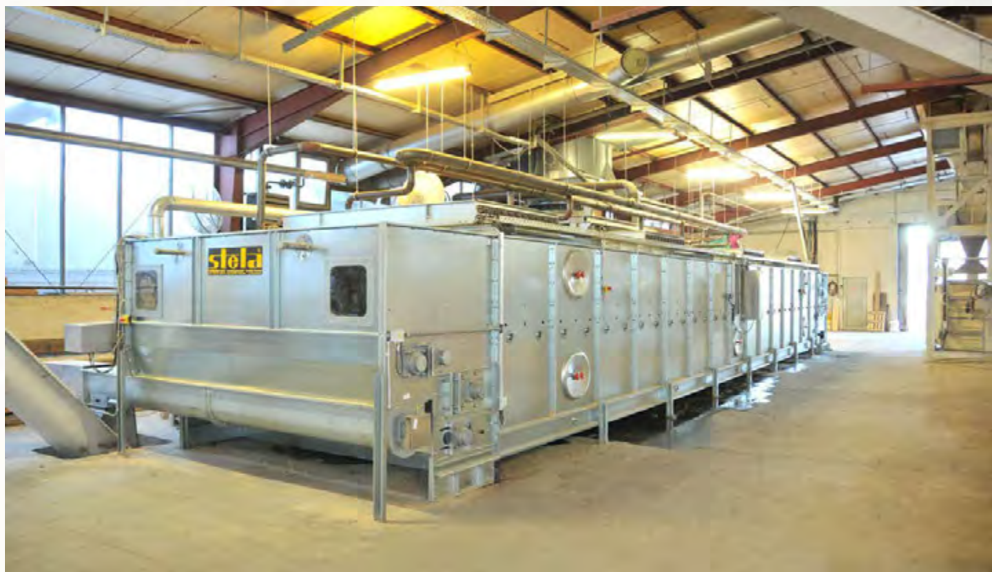
项目地：G. & E. Zimmermann, 德国 | 型号：BTL 1/3000-15 | 安装年份：2010 干燥物料：木屑 | 出料能力：约2.0吨/小时 | 降水区间：50% -10%湿度
