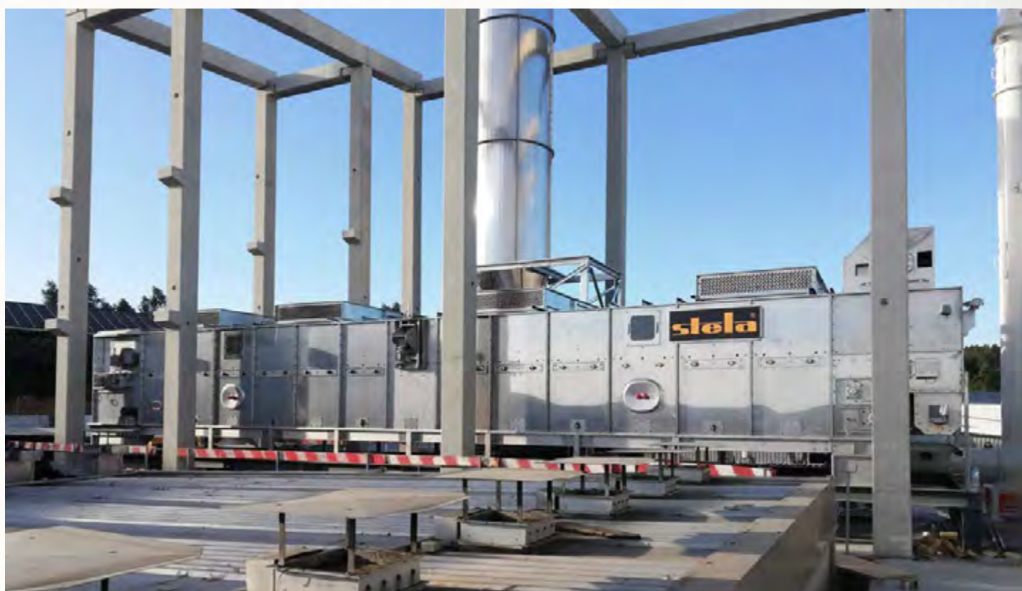
项目地：Palser Bioenergia e Paletes, 葡萄牙 | 型号：BTL 1/3000-13 | 安装年份：2019 干燥物料：木屑 | 出料能力：约2.15吨/小时 | 降水区间：46% - 2%湿度
