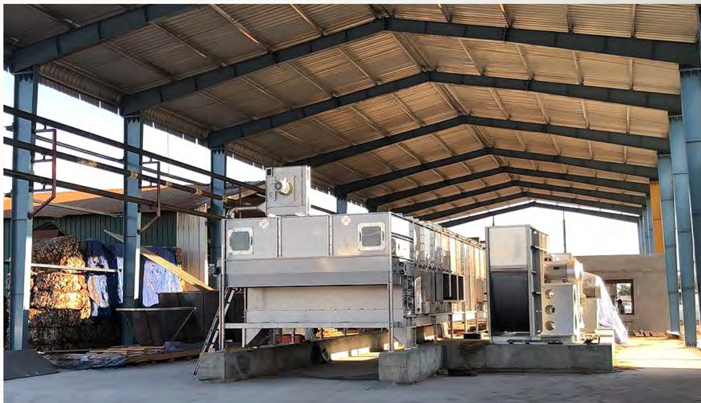
项目地：Remmy Substrates, 印度 | 型号：BTL 1/3000-18 | 安装年份：2020 干燥物料：椰壳纤维 | 出料能力：约2.0吨/小时 | 降水区间：50-60% - <15%湿度
