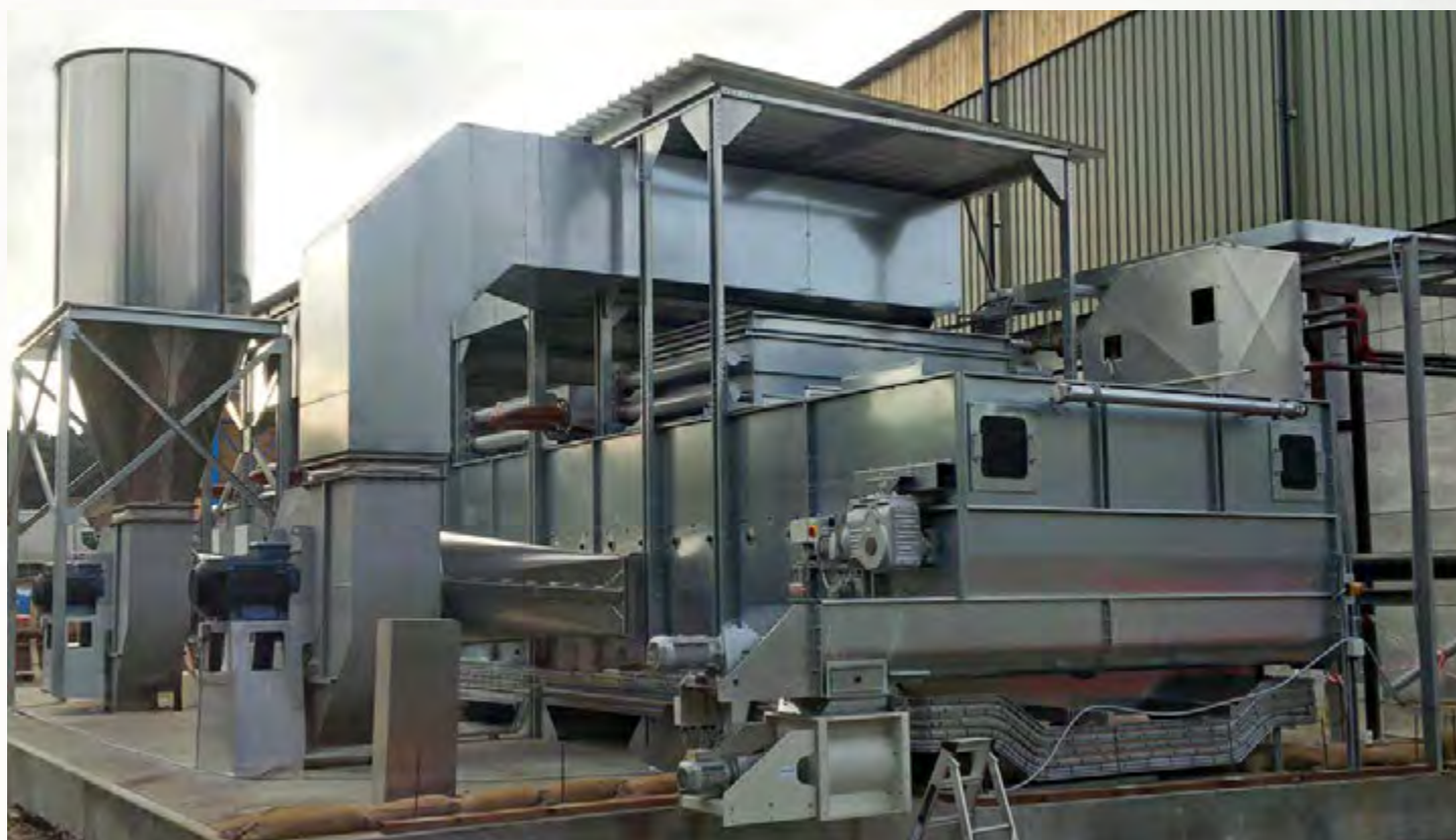
项目地：For wood Production Limited, 英国 | 型号：BTLU 1/3000-14 | 安装年份：2016 干燥物料：木屑、木片 | 出料能力：约3.75吨/小时 | 降水区间：55% - 30%湿度
