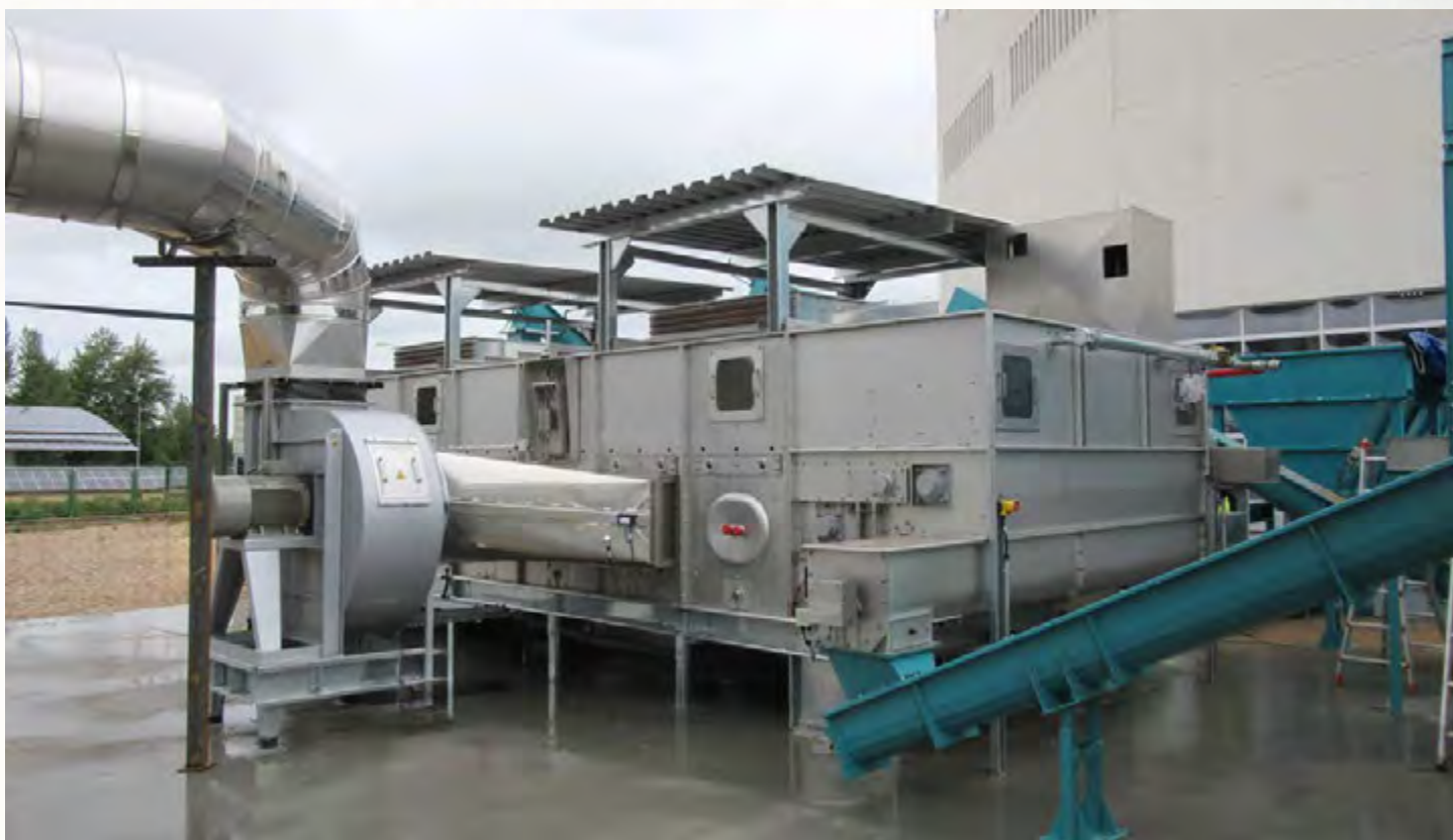
项目地：Productos Capilares L'Oreal S.A., 西班牙 | 型号：BTL 1/3000-6 | 安装年份：2014 干燥物料：污泥与木屑混料 | 出料能力：约0.66吨/小时 | 降水区间：65% - 10%湿度
