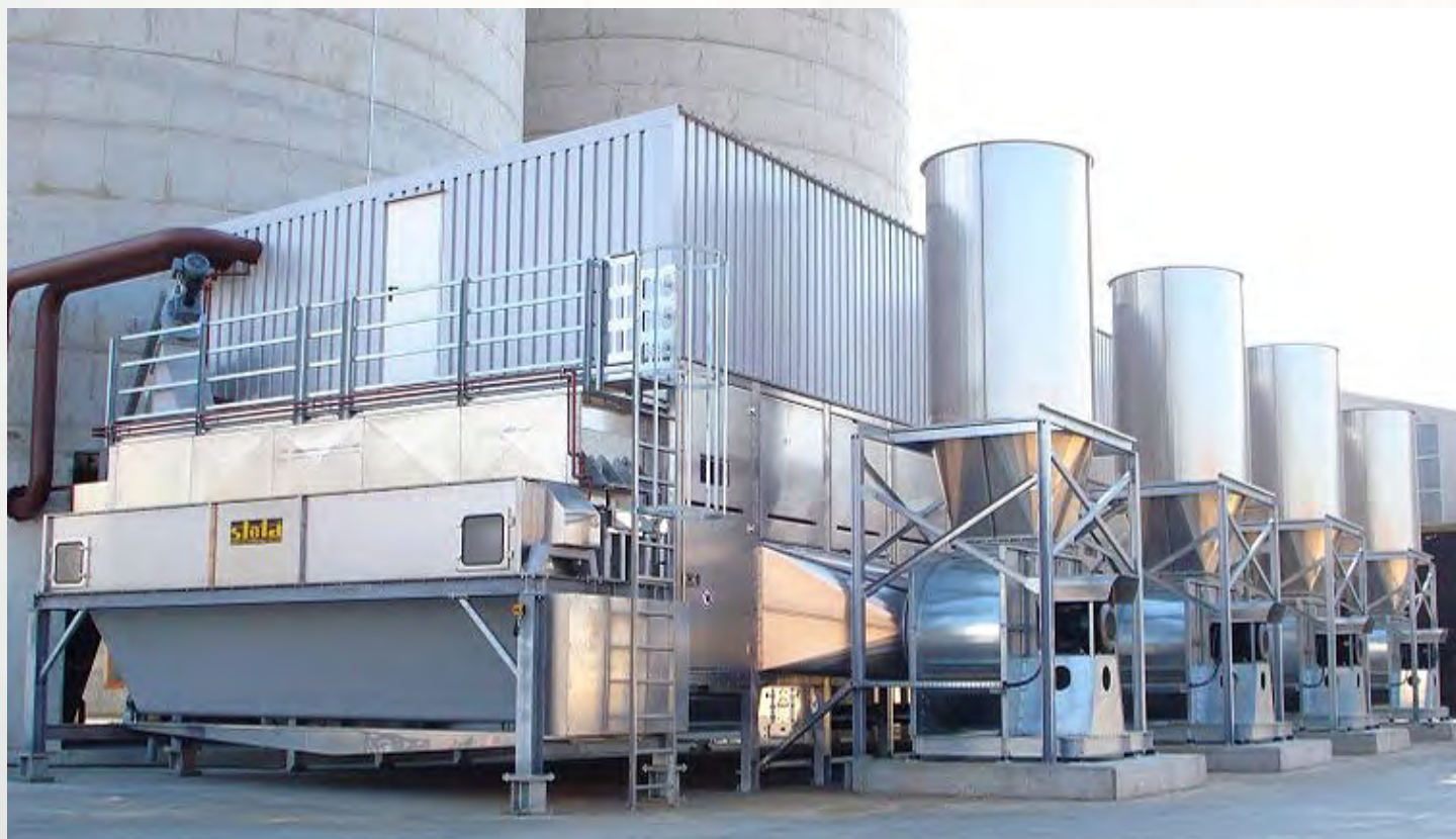
项目地：Lvivpak, 乌克兰 | 型号：BTL 1/3000-11 | 安装年份：2022 干燥物料：木屑 | 出料能力：约2.1吨/小时 | 降水区间：45% - 10%湿度
