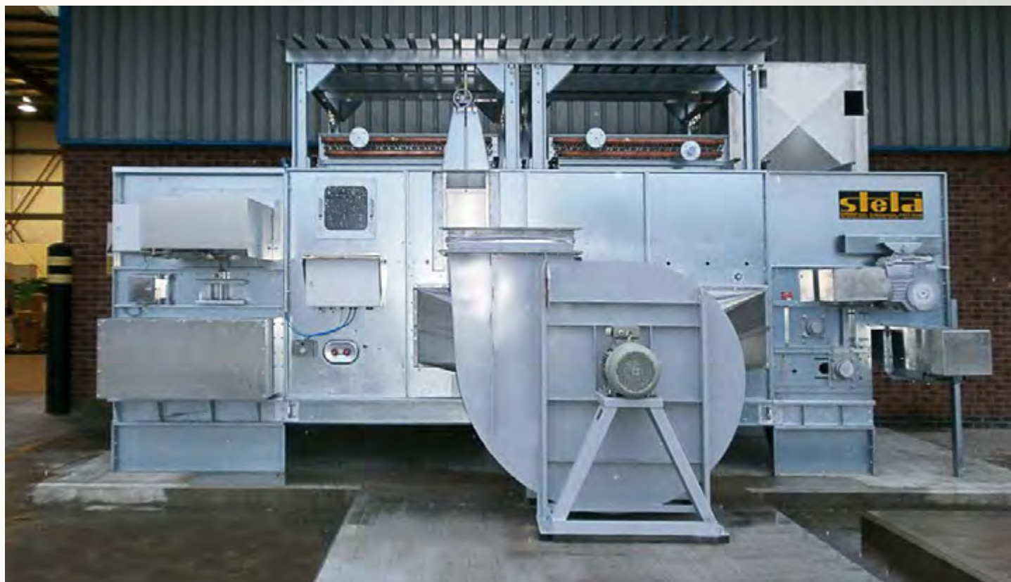
项目地：Intervate Limited, 英国 | 型号：BTL 1/2000-4 | 安装年份：2013 干燥物料：木屑 | 出料能力：约2.1吨/小时 | 降水区间：30% - 10%湿度
