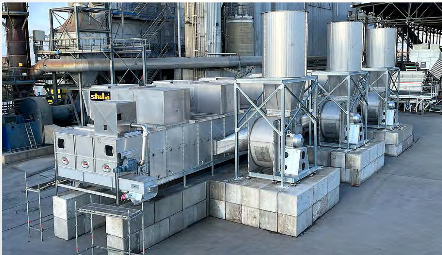
项目地: Repsan Energy SRL, 罗马尼亚 | 型号: BTL 1/3000-26 | 安装年份: 2022 干燥物料: RDF垃圾燃料/MSW城市固废 | 出料能力: 约10.8吨/小时 | 降水区间: 40% - 25%湿度
