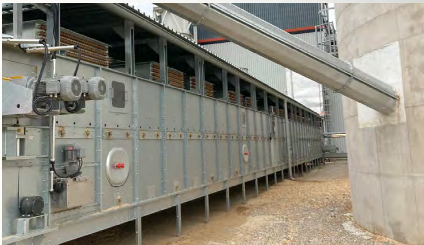
项目地：Biomasse Heizkraftwerk Sollenau, 奥地利 | 型号：BTL 1/3000-6 | 安装年份：2021 干燥物料：木屑 | 出料能力：约5.56吨/小时 | 降水区间：50% - 10 %湿度
