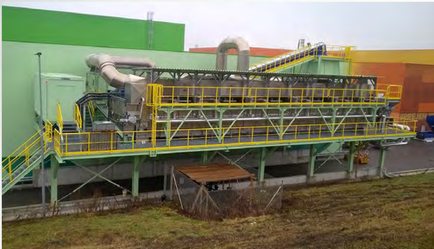
项目地：Strabag AG RCERO, 斯洛文尼亚 | 型号：BTLU 1/3000-54 | 安装年份：2018 干燥物料：MSW城市固废 | 出料能力：约6.75吨/小时 | 降水区间：28% - 15%湿度
