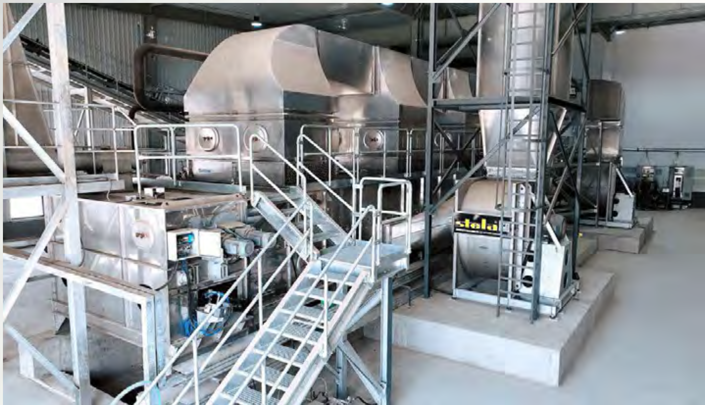
项目地：路德环境，中国 | 型号：BTLU 1/3000-23 | 安装年份：2024 干燥物料：酒糟 | 出料能力：约6.74吨/小时 | 降水区间：40% - 11%湿度
