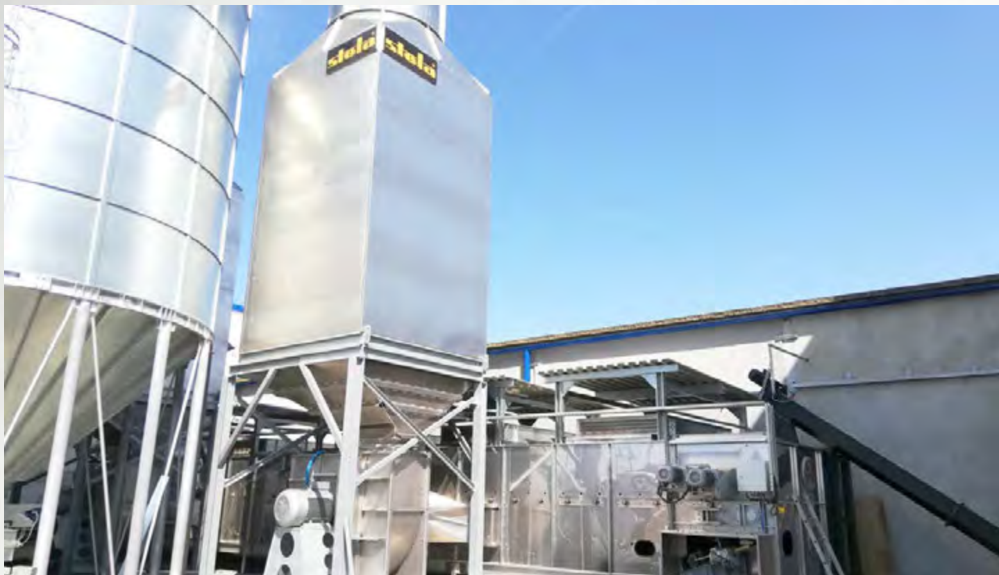
项目地：PPUH Gabi Jerczyscy, 波兰 | 型号：BTL 1/3000-17 | 安装年份：2019 干燥物料：木屑刨花 | 出料能力：约2.5吨/小时 | 降水区间：50% - 10%湿度
