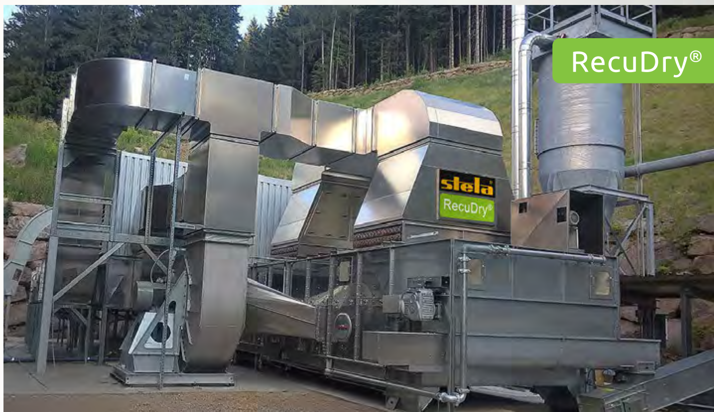
项目地：Federer Pellets GmbH, 意大利 | 型号：BTLU RecuDry 1/3000-15 | 安装年份：2017 干燥物料：木屑 | 出料能力：约2.1吨/小时 | 降水区间：50% - 10%湿度
