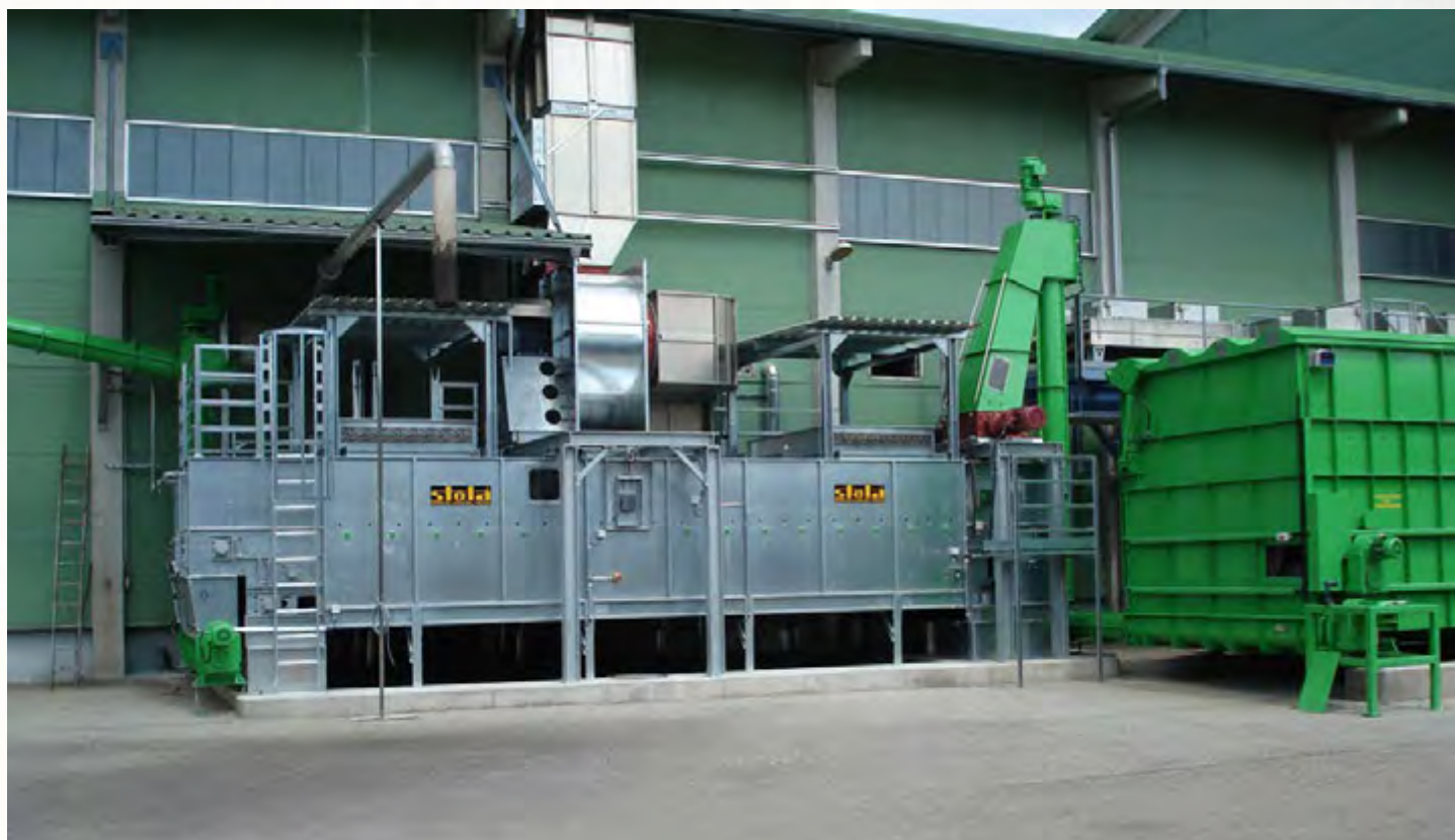
项目地：Wurzer Umwelt, 德国 | 型号：BTL 1/3000-8 | 安装年份：2012 干燥物料：消化污泥 | 出料能力：约0.36吨/小时 | 降水区间：60% - 10-20 %湿度
