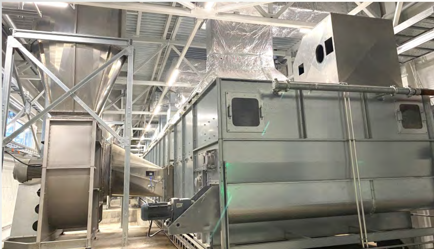
项目地：AO S-DOK, 俄罗斯 | 型号：BTL 1/3000-27 | 安装年份：2021 干燥物料：木屑 | 出料能力：约4.6吨/小时 | 降水区间：55% - 10%湿度
