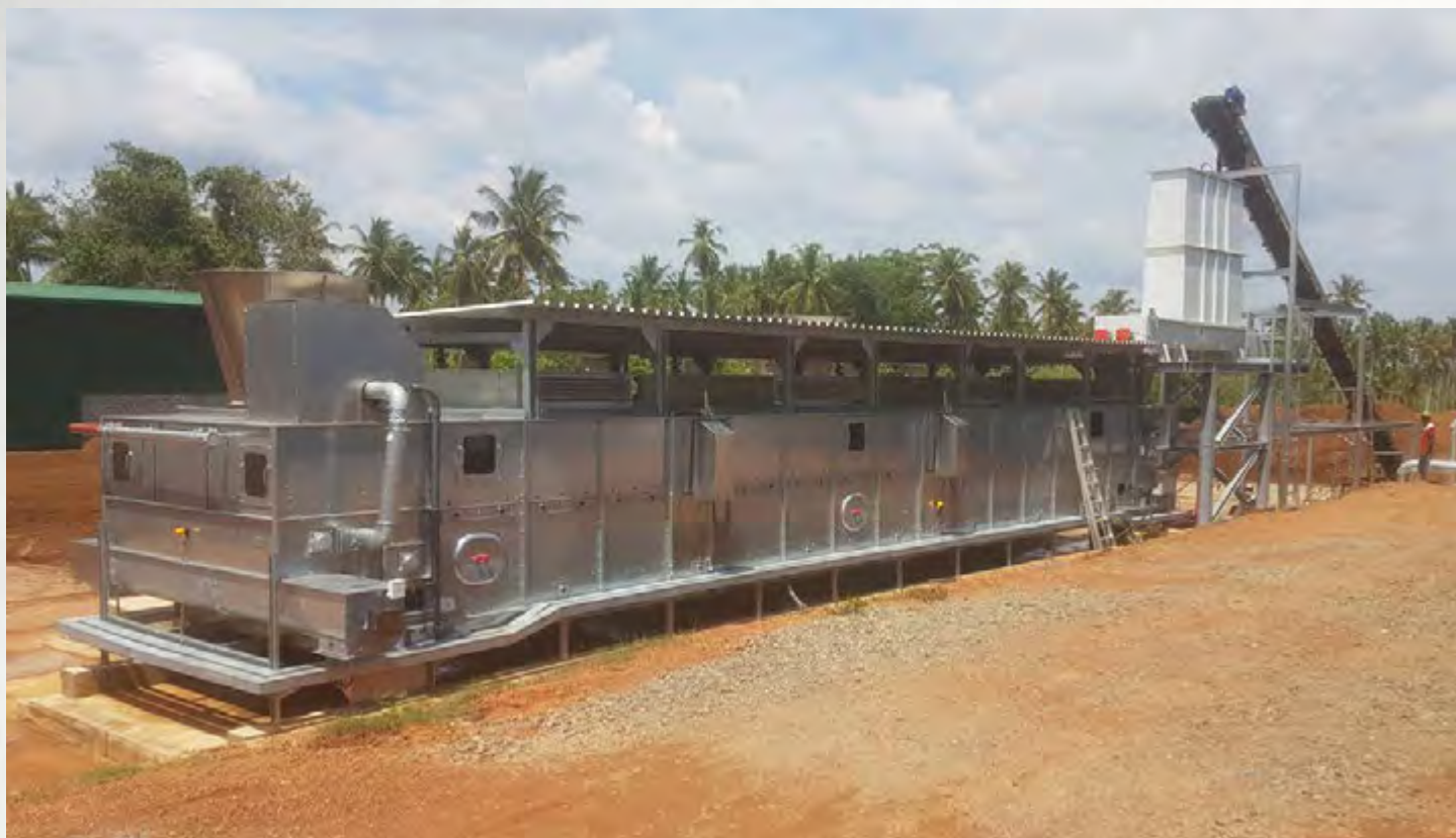
项目地：Botanicoir Lankan Pvt., 斯里兰卡 | 型号：BTL 1/3000-15 | 安装年份：2017 干燥物料：椰糠 | 出料能力：约1.25吨/小时 | 降水区间：65% - 22%湿度
