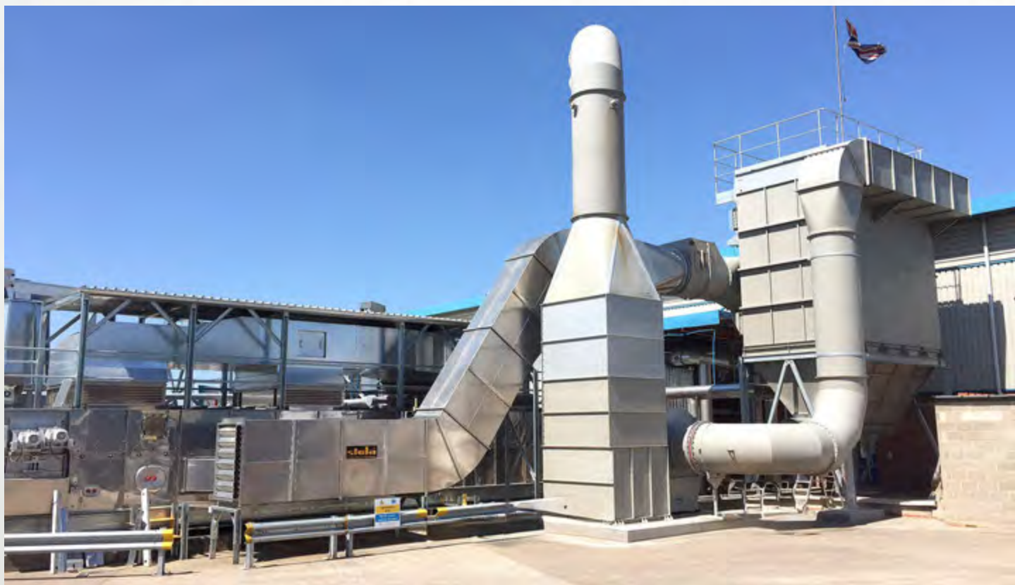
项目地：Flisher Energy, 英国 | 型号：BTLU 1/3000-16 | 安装年份：2016 干燥物料：木屑 | 出料能力：约3.0吨/小时 | 降水区间：45% - 15% 湿度
