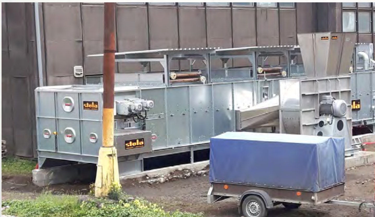
项目地：OFZ Istebene, 斯洛文尼亚 | 型号：BTL 1/3000-12 | 安装年份：2017 干燥物料：木屑 | 出料能力：约2.0吨/小时 | 降水区间：50% - 12%湿度
