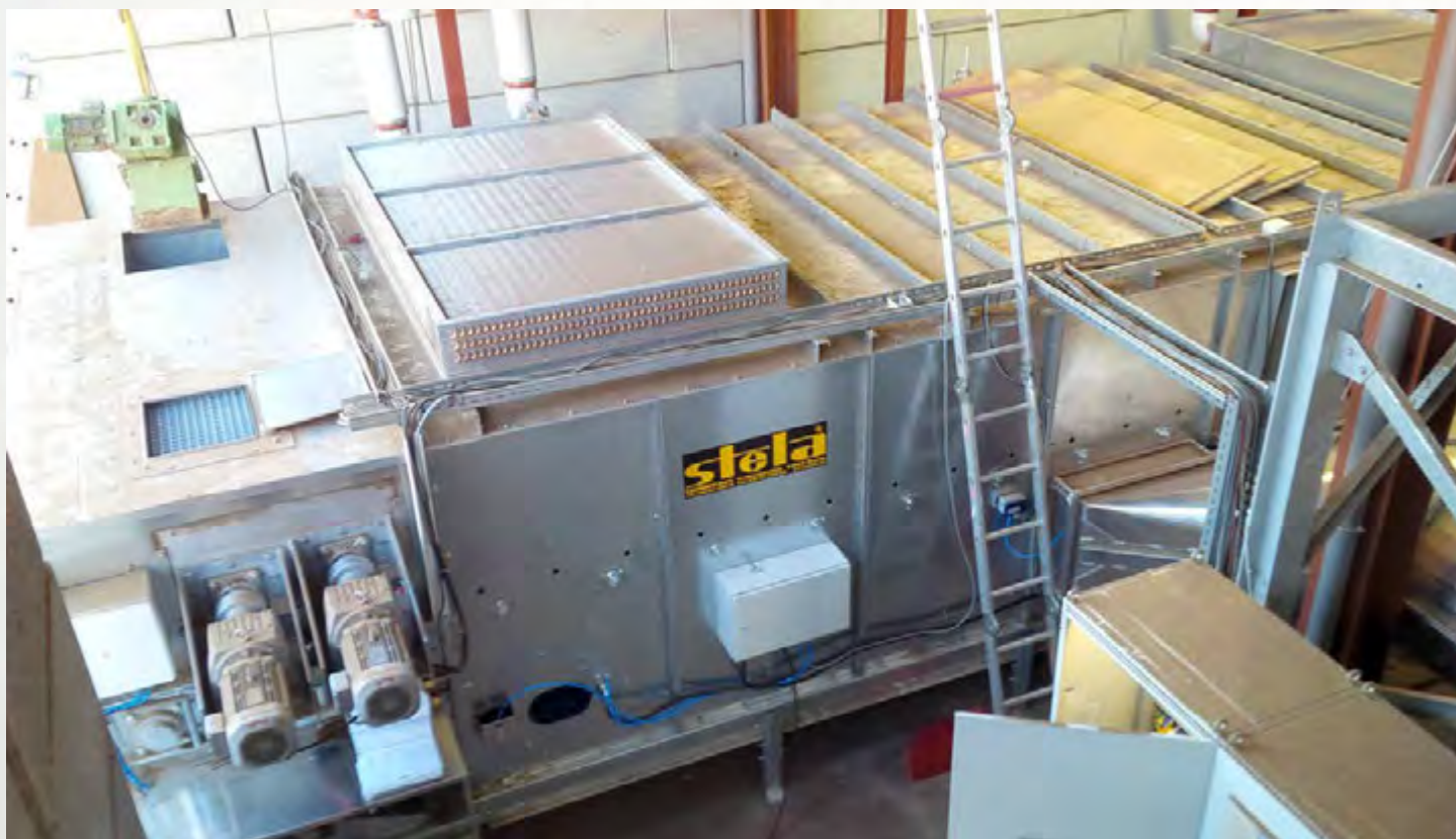
项目地：EMICHAFFLO, SA., 比利时 | 型号：BTL 1/3000-8 | 安装年份：2013 干燥物料：木片 | 出料能力：约1.3吨/小时 | 降水区间：50% - 20%湿度
