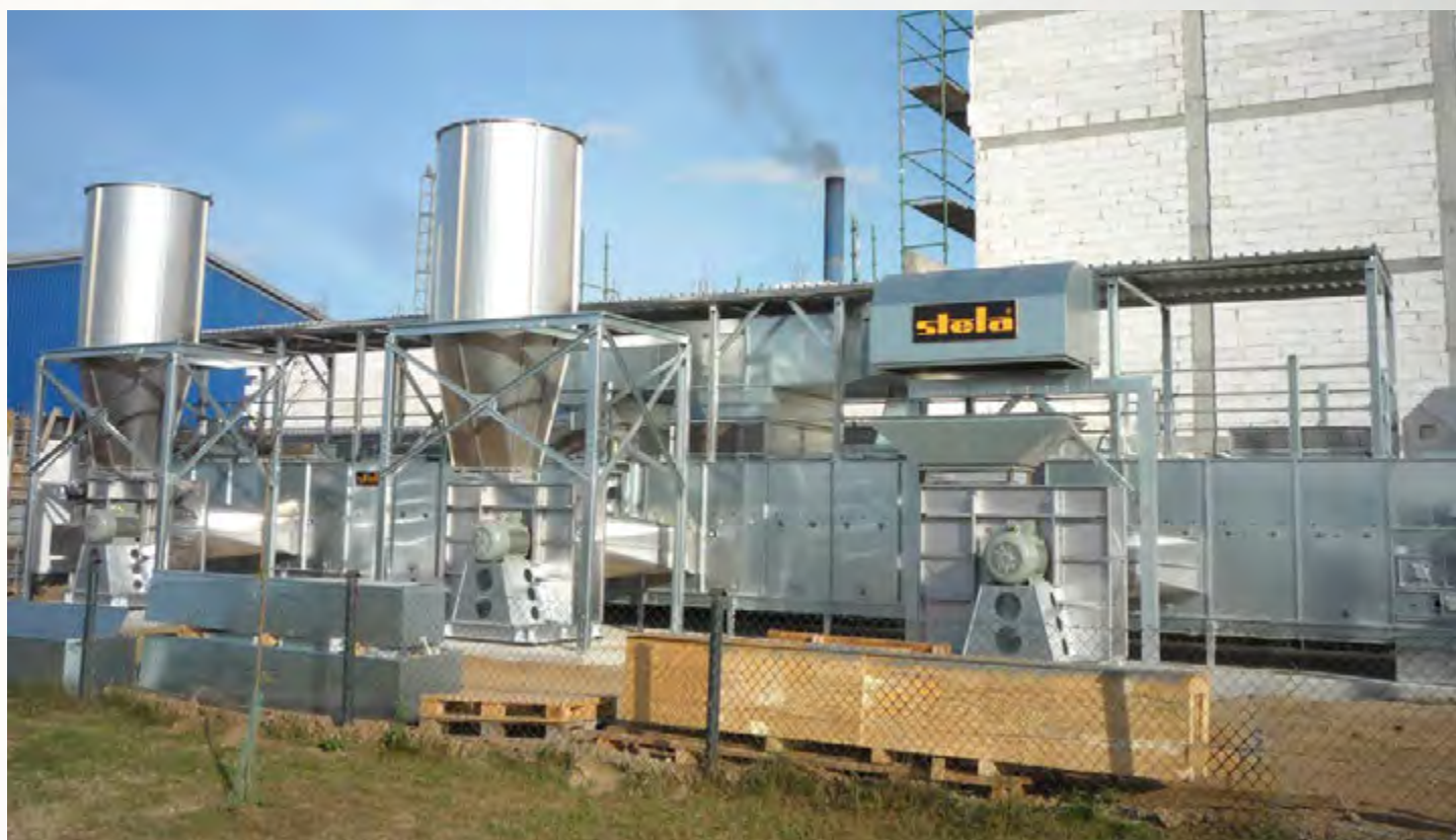
项目地：Polima Sp. z.o.o., 波兰 | 型号：BTLU 1/3000-22 | 安装年份：2016 干燥物料：木屑 | 出料能力：约3.0吨/小时 | 降水区间：50% - 2%湿度
