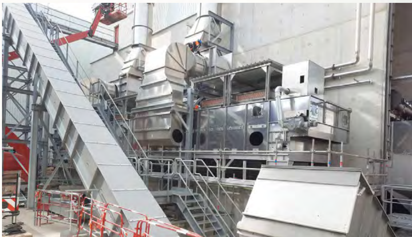
项目地：Blue Paper SAS, 法国 | 型号：BTL 1/3000-20 | 安装年份：2023 干燥物料：Rejects 垃圾燃料（塑料和纤维） | 出料能力：约3.0吨/小时 | 降水区间：45% - 8-10%湿度
