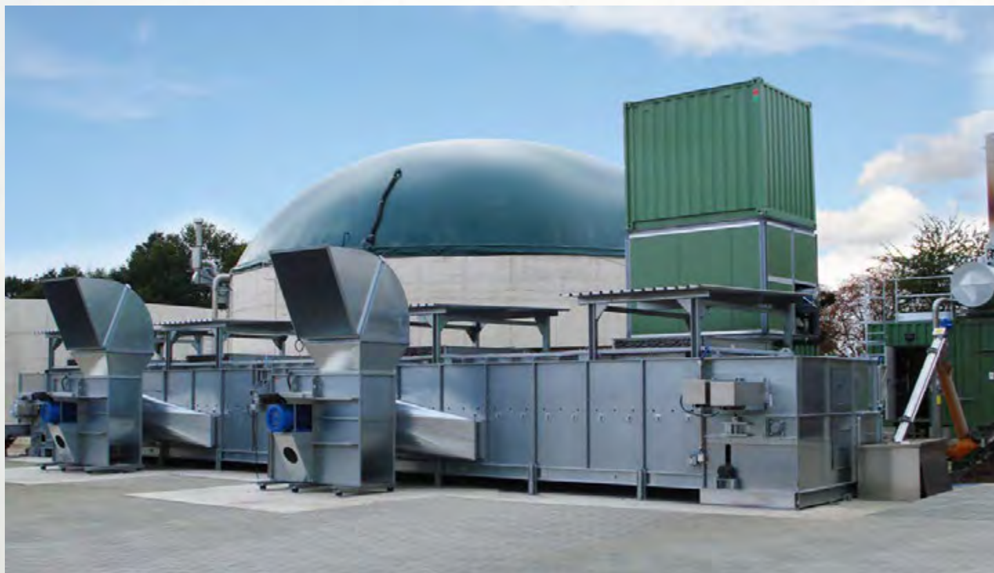
项目地：Areva, 德国 | 型号：BTL 1/3000-18 安装年份：2009 | 干燥物料：消化污泥
