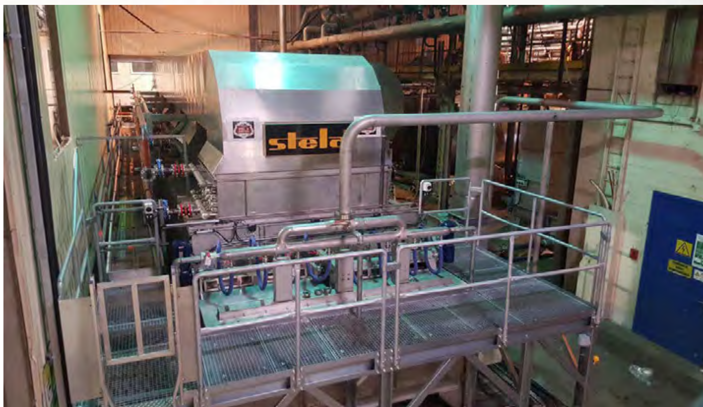
项目地: Ecoson, 比利时 | 型号: BTLU 1/3000-18 | 安装年份: 2020 干燥物料: 消化污泥 | 出料能力: 约0.13吨/小时 | 降水区间: 85% - 5%湿度
