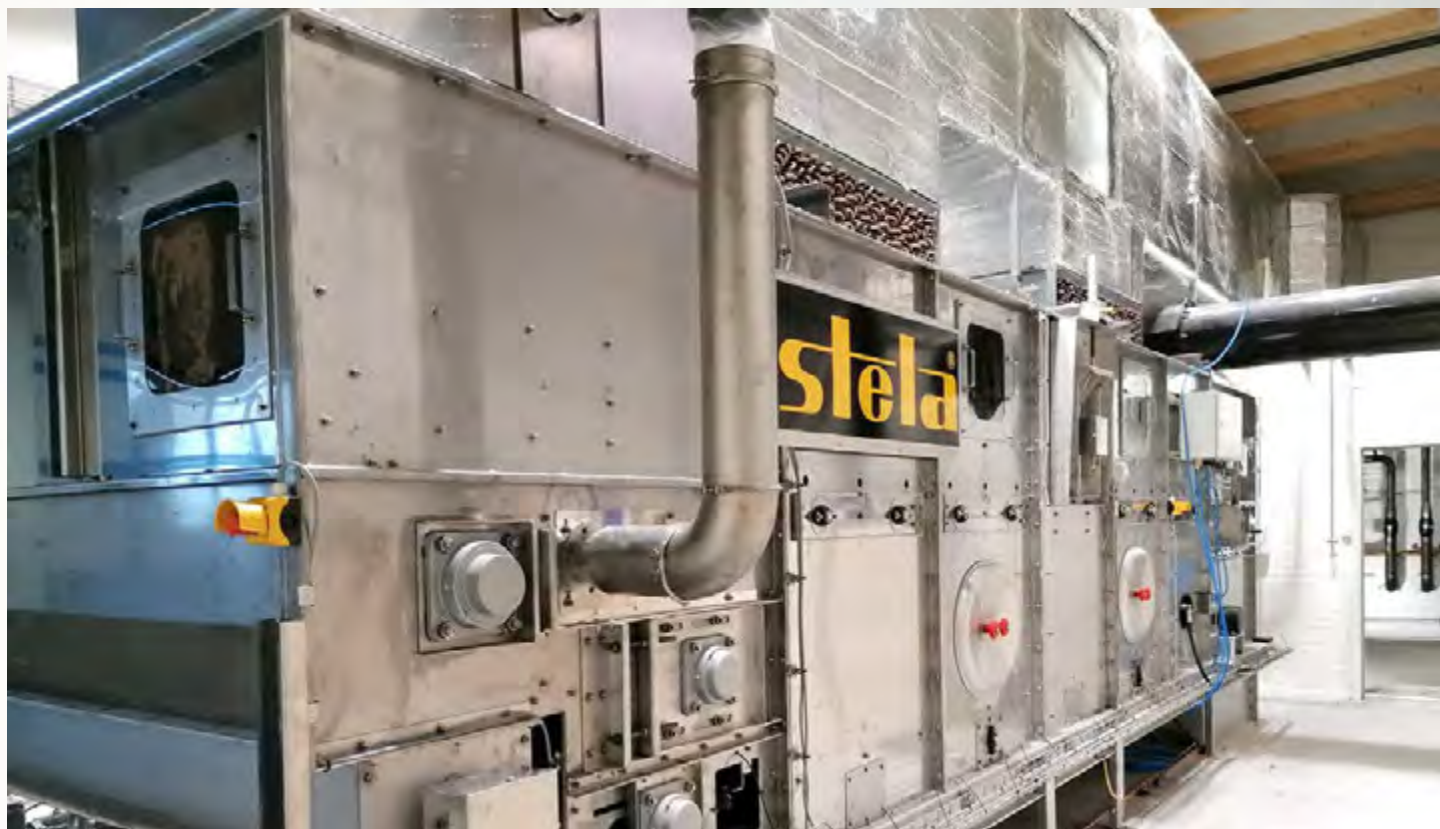
项目地：Oplandske Bioenergi, 挪威 | 型号：BTL 1/2000-5 | 安装年份：2020 干燥物料：木屑马粪混料 | 出料能力：约0.44吨/小时 | 降水区间：50% - 15%湿度
