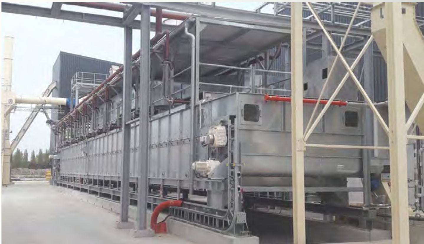
项目地：Rursus N.V., 比利时 | 型号：BTLU 1/3000-31 | 安装年份：2017 干燥物料：碎木片、木屑 | 出料能力：约8.75吨/小时 | 降水区间：30% - 2%湿度
