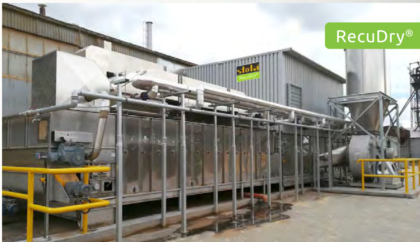
项目地：Poltarex, 波兰 | 型号：BTLU RecuDry 1/3000-16 | 安装年份：2020 干燥物料：木屑 | 出料能力：约2.0吨/小时 | 降水区间：50% -5%湿度
