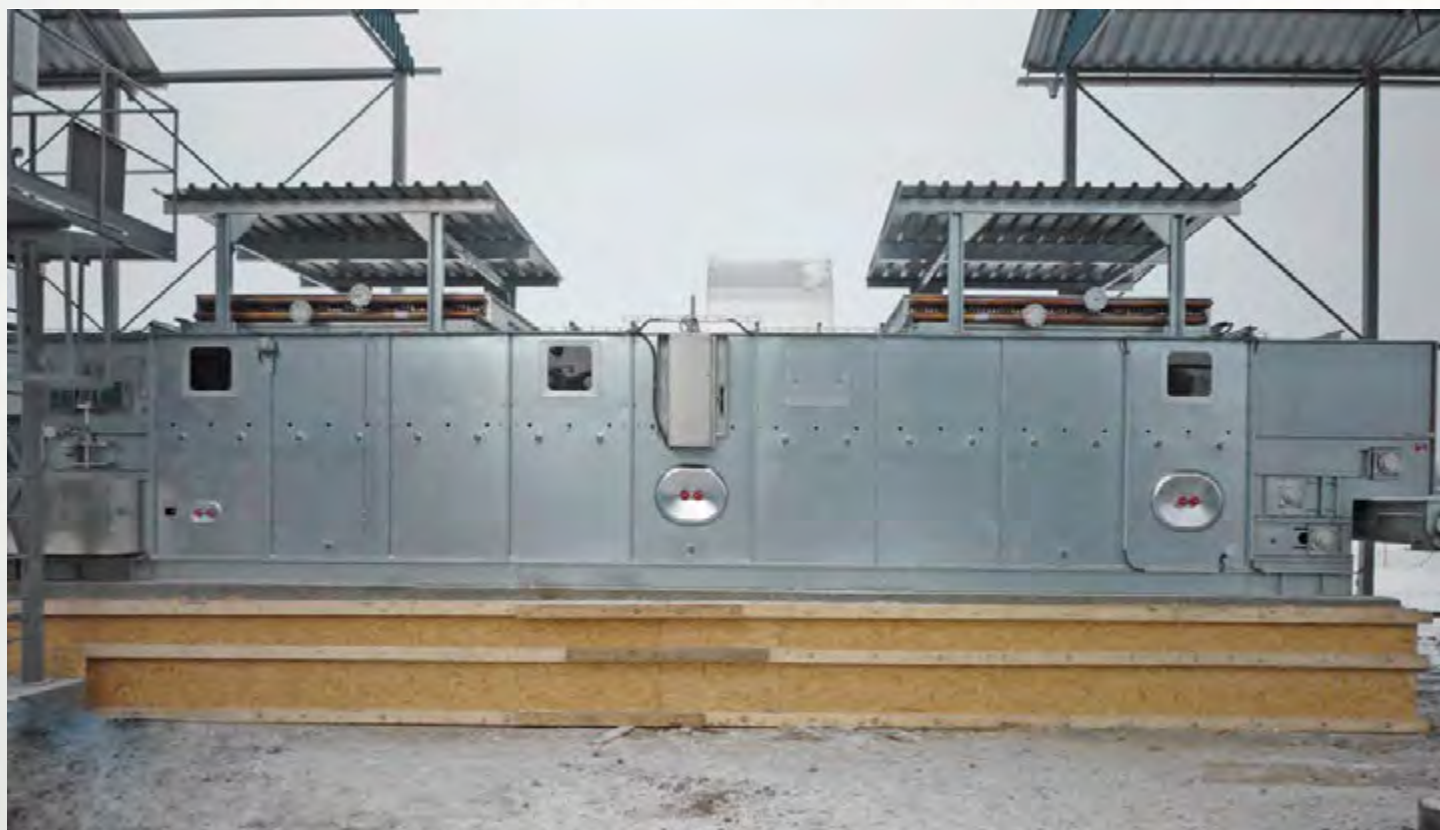
项目地: Power Design Location, 捷克 | 型号: BTL 1/3000-9 S (1000KW) | 安装年份: 2013 干燥物料: 消化污泥 | 出料能力: 约0.31吨/小时 | 降水区间: 75% - 15%湿度
