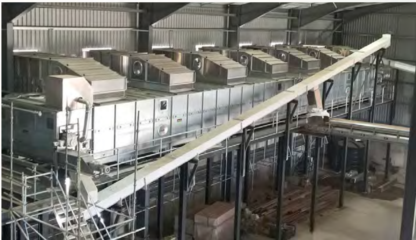
项目地：Stanley's Quarry, 英国 | 型号：BTL 1/3000-26 | 安装年份：2017 干燥物料：木片、木屑 | 出料能力：约5.8吨/小时 | 降水区间：50% - 25% 湿度
