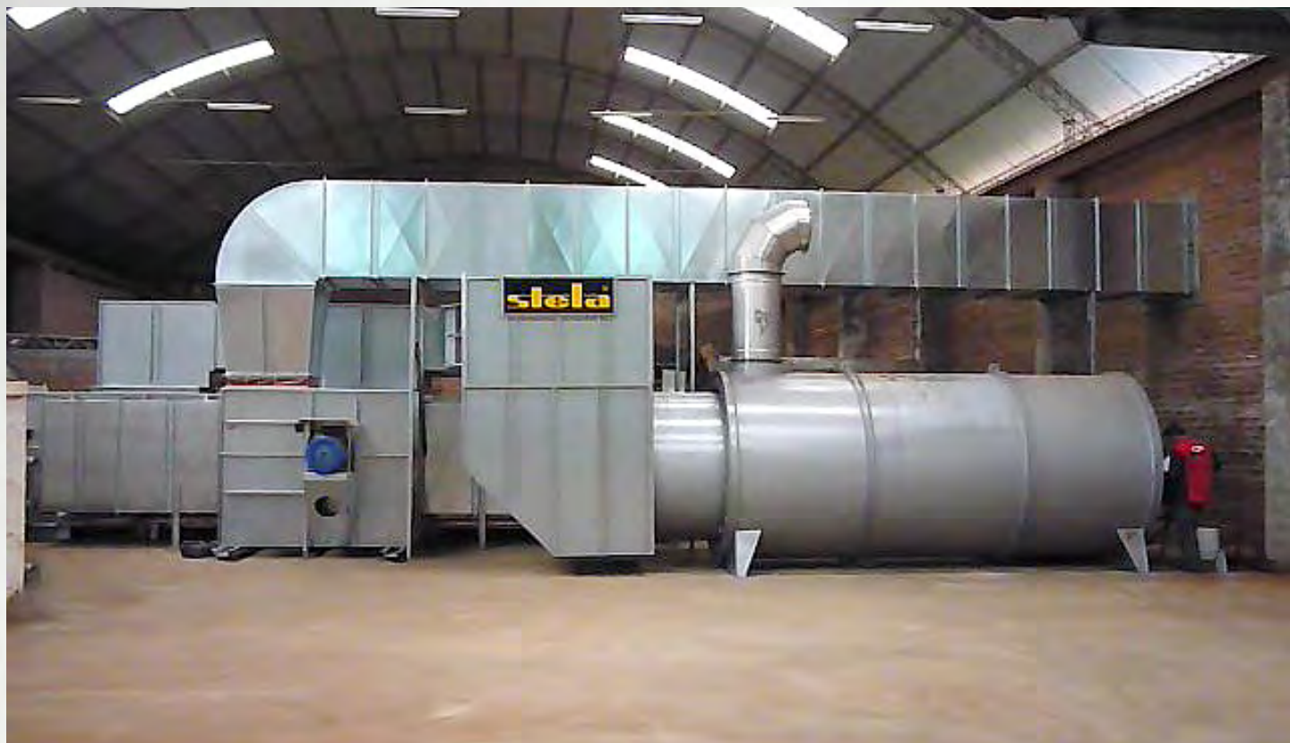
项目地：Präventiv Produkte, 奥地利 | 型号：BTL 1/3000-8 | 安装年份：2010 干燥物料：Bokashi | 出料能力：约3.0吨/小时 | 降水区间：28% -10%湿度
