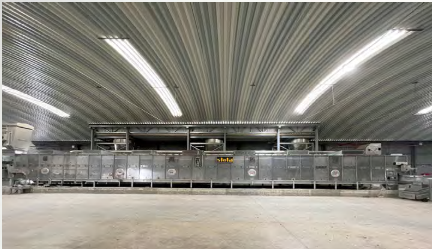
项目地：Bianna Recycling Proj. Amilital, 葡萄牙 | 型号：BTL 1/3000-28 | 安装年份：2021 干燥物料：RDF垃圾燃料 | 出料能力：约4.6吨/小时 | 降水区间：48% - 14%湿度
