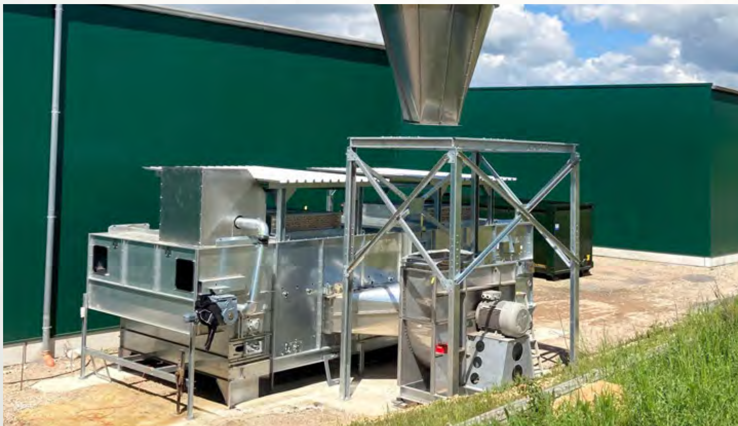
项目地：Holzwerke Michael Menz GmbH & Co. KG, 德国 | 型号：BTL 1/3000-6 | 安装年份：2021 干燥物料：木屑 | 出料能力：约1.6吨/小时 | 降水区间：40% - 10%湿度
