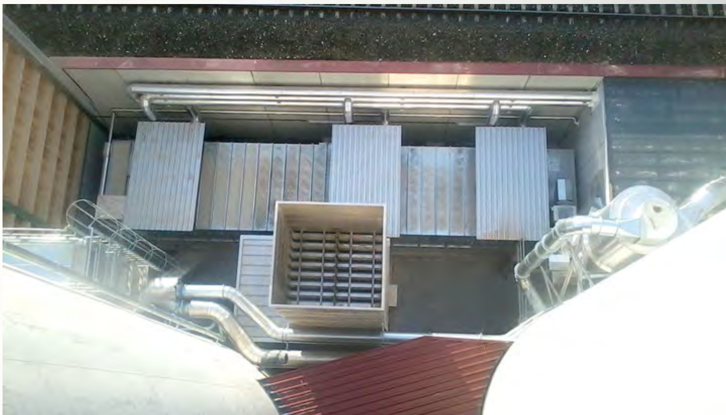
项目地：Schmidt Energieproduktions GmbH 奥地利 | 型号：BTL 1/3000-14 | 安装年份：2013 干燥物料：木屑 | 出料能力：约2.0吨/小时 | 降水区间：50% - 10%湿度
