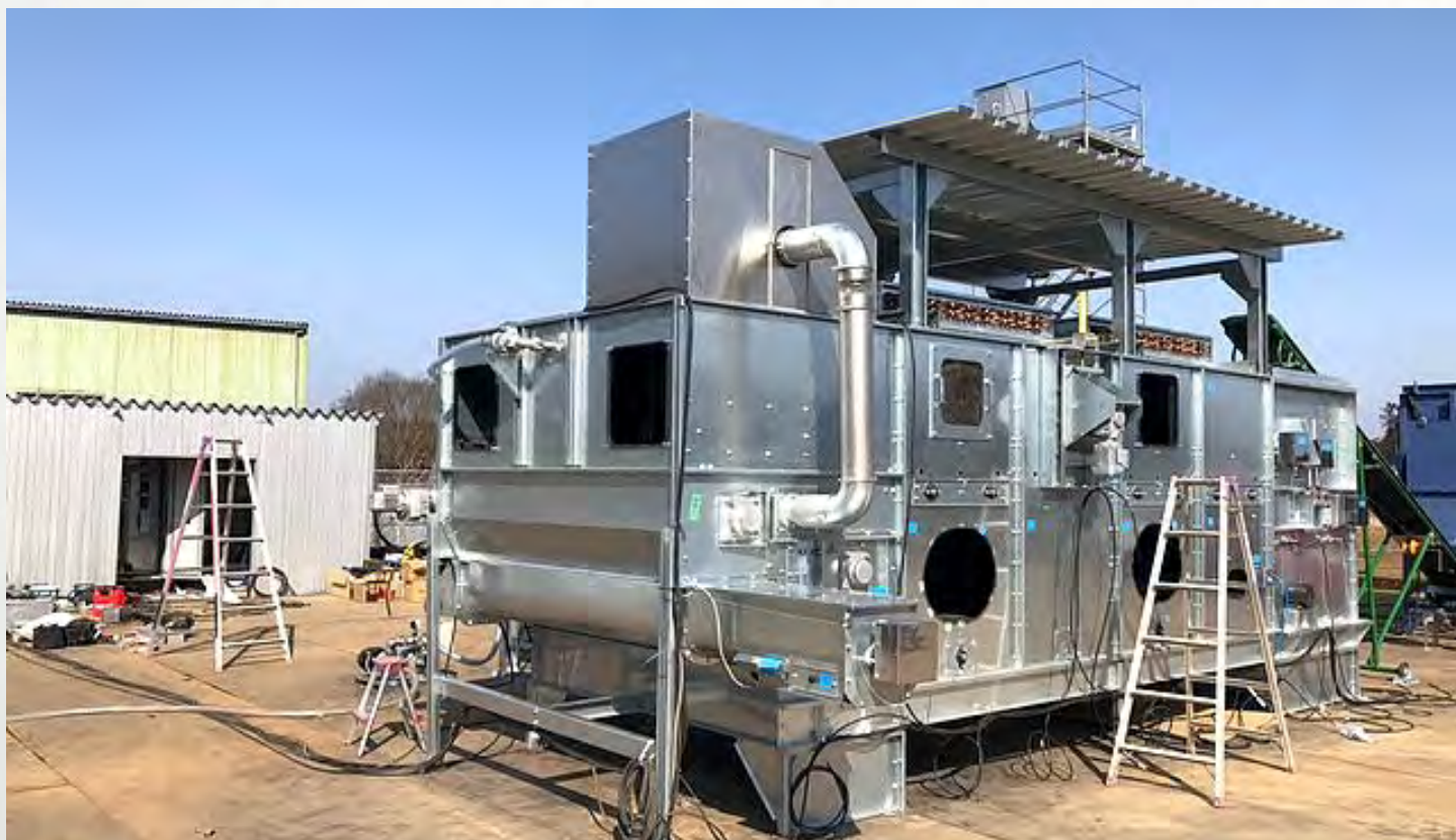
项目地：Daiki Sasaki, 日本 | 型号：BTL 1/2000-4 | 安装年份：2020 干燥物料：木片 | 出料能力：约0.4吨/小时 | 降水区间：50% - 15%湿度
