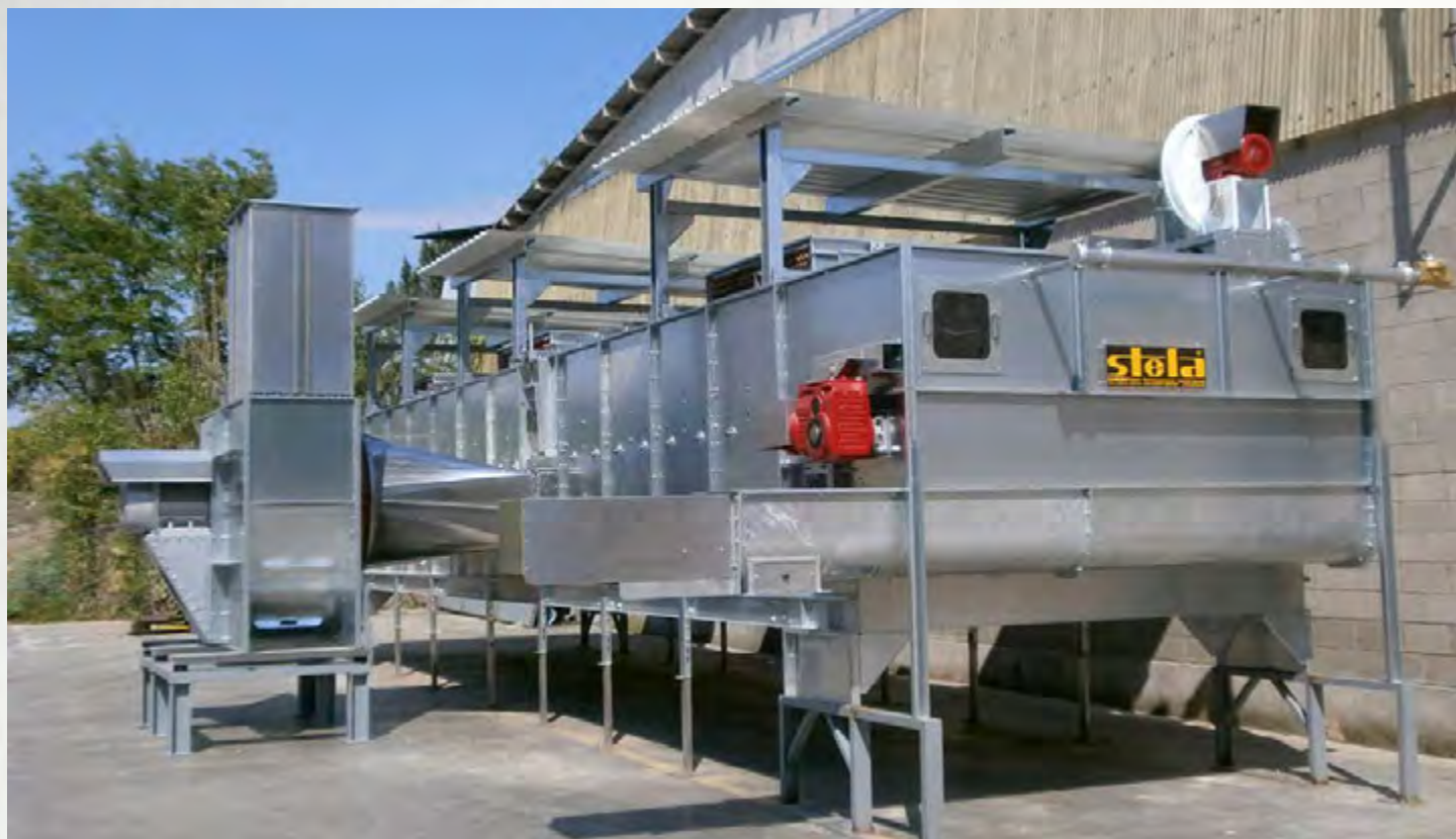
项目地：Pallets J. Martorell S.A., 西班牙 | 型号：BTL 1/3000-11 | 安装年份：2013 干燥物料：木屑 | 出料能力：约2.2吨/小时 | 降水区间：45% - 10%湿度
