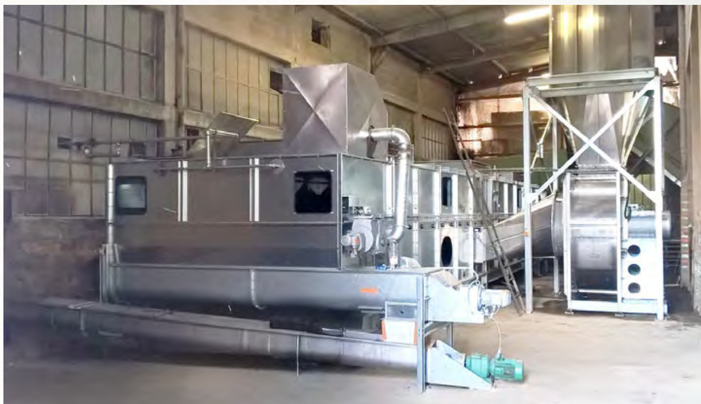
项目地：Bioval, 法国 | 型号：BTL 1/3000-11 | 安装年份：2018 干燥物料：木屑 | 出料能力：约1.75吨/小时 | 降水区间：50% - 10%湿度
