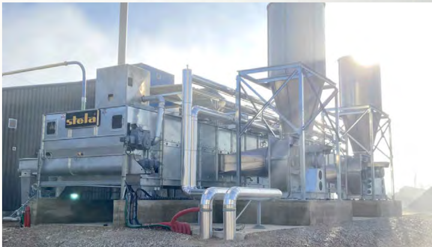
项目地：Enerphyt, 法国 | 型号：BTL 1/3000-16 | 安装年份：2023 干燥物料：木屑 | 出料能力：约3.05吨/小时 | 降水区间：45% - 10%湿度
