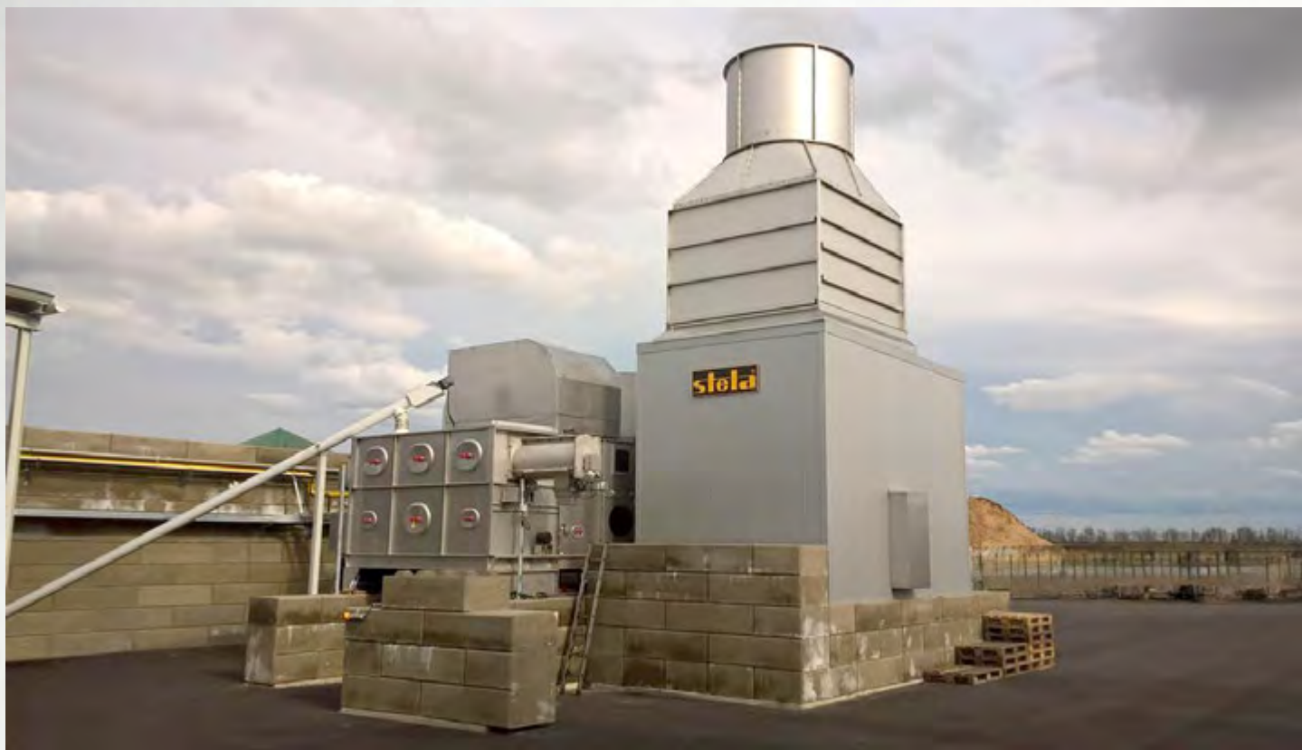
项目地：GSCL Lagerlogistik, 德国 | 型号：BTL 1/3000-7 | 安装年份：2016 干燥物料：活性炭 | 出料能力：约0.5吨/小时 | 降水区间：50% - <5%湿度
