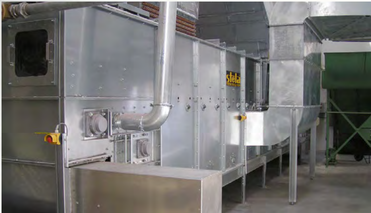
项目地：Látóp Tabor, 捷克 | 型号：BTL 1/3000-9 | 安装年份：2014 干燥物料：木屑 | 出料能力：约2.1吨/小时 | 降水区间：40% - 12%湿度
