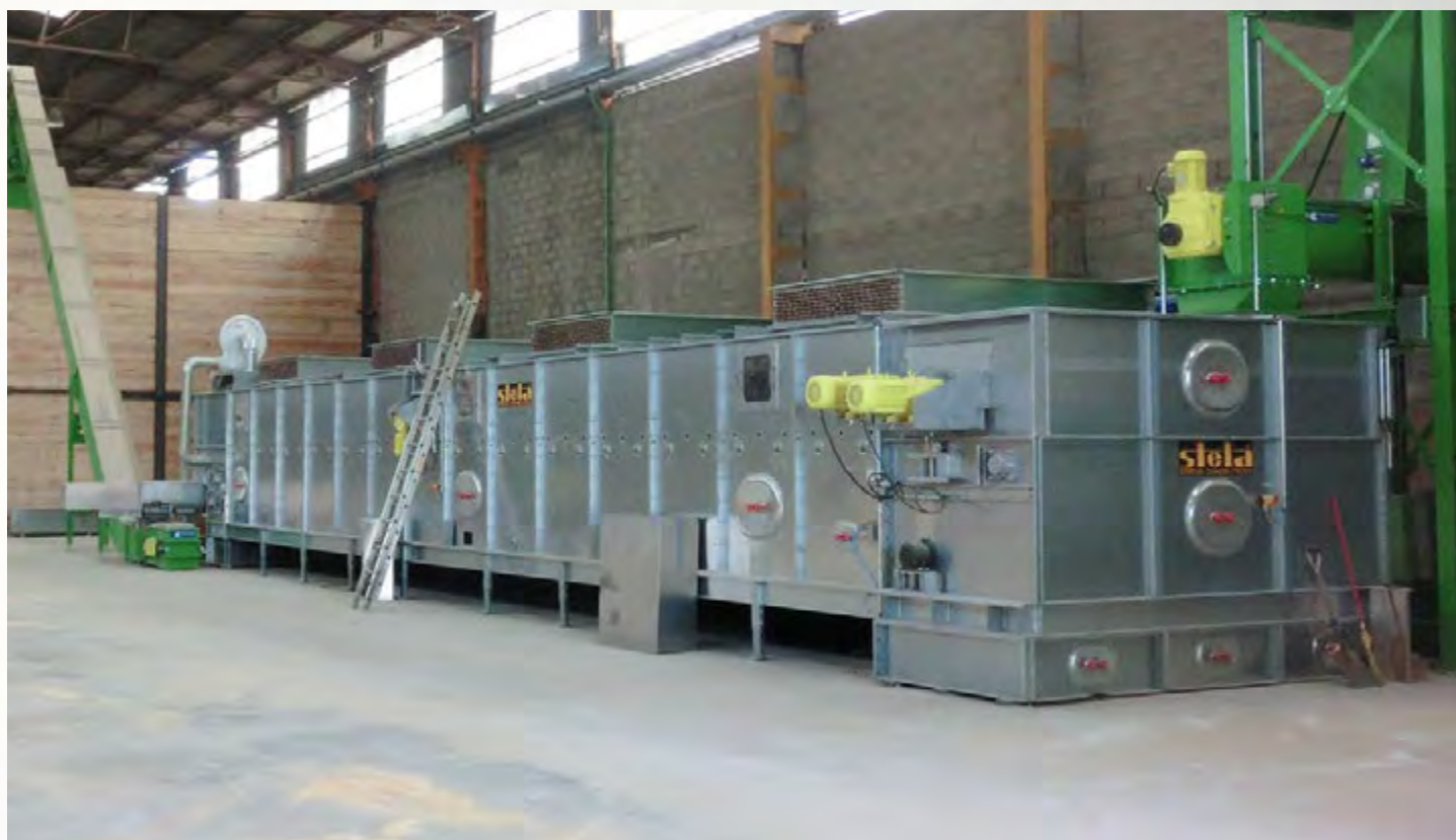
项目地：Manipulados del Noya, 西班牙 | 型号：BTL 1/3000-14 | 安装年份：2012 出料能力：木屑约2.6吨/小时 | 降水区间：45% - 10%湿度 | 出料能力：木片约3.7吨/小时 | 降水区间：45% - 20%湿度
