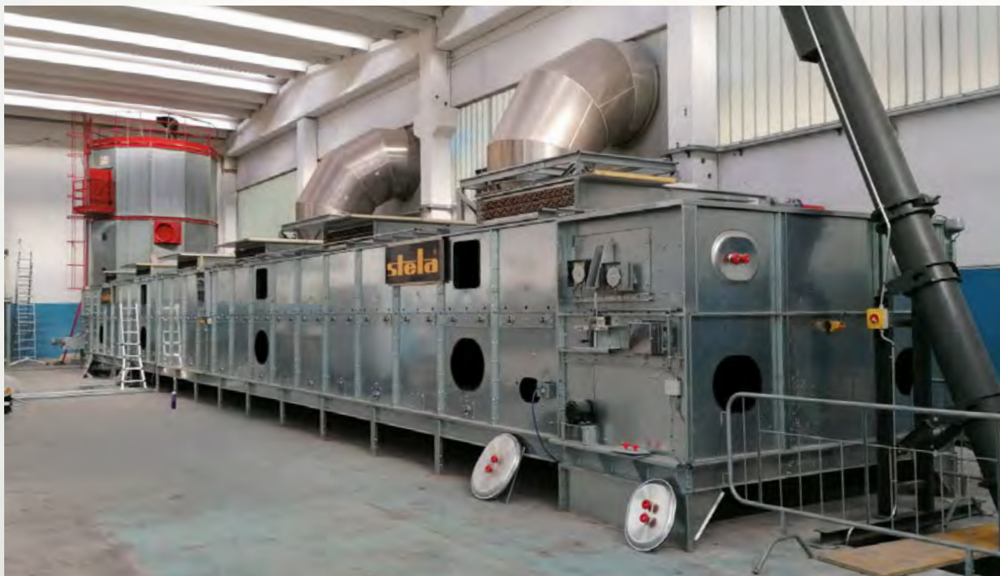
项目地：Meccanica Gervasoni, 意大利 | 型号：BTL 1/3000-22 | 安装年份：2020 干燥物料：木屑 | 出料能力：约4.0吨/小时 | 降水区间：50% - 8%湿度
