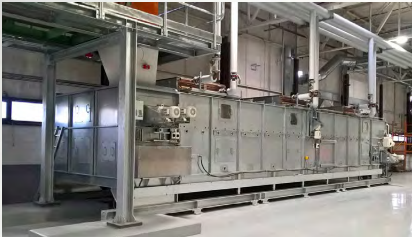
项目地：Palettereie Francois, 比利时 | 型号：BTL 1/3000-10 | 安装年份：2016 干燥物料：木屑、碎木片 | 出料能力：约2.0吨/小时 | 降水区间：40% - 3%湿度
