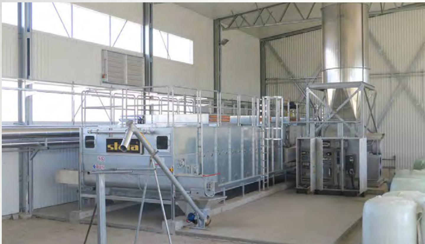
项目地：CHP Energie Biogas, 波兰 | 型号：BTL 1/3000-15 | 安装年份：2014 干燥物料：消化污泥 | 出料能力：约2.67吨/小时 | 降水区间：44% - 12%湿度
