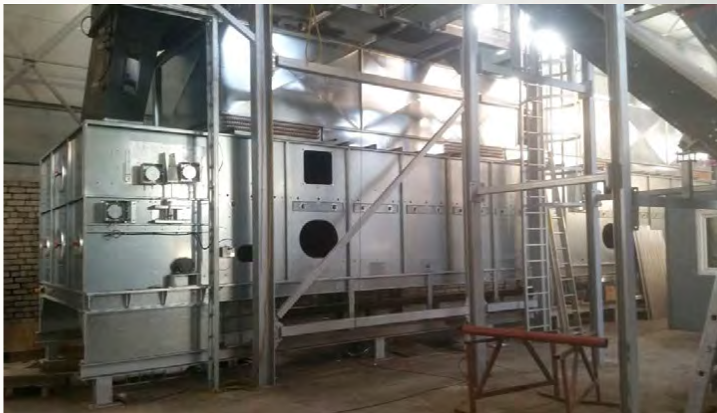
项目地：INOS Ltd, 拉脱维亚 | 型号：BTL 1/3000-15 | 安装年份：2015 干燥物料：泥炭、谷物 | 出料能力：约2.75吨/小时 | 降水区间：50% - 20%湿度
