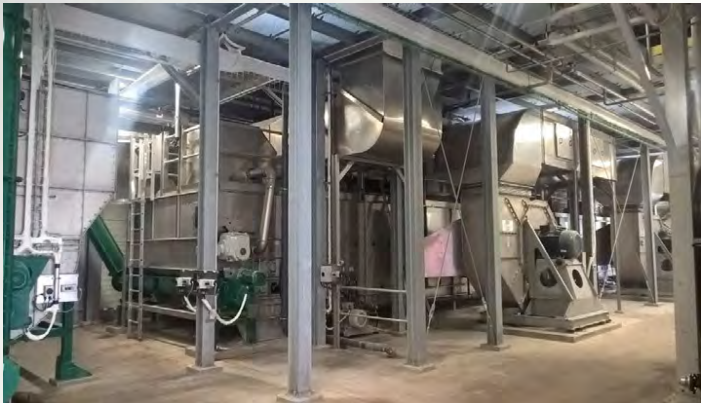
项目地：Strabag, 比利时 | 型号：BTLU 2/3000-16 | 安装年份：2017 干燥物料：消化污泥 | 出料能力：约1.86吨/小时 | 降水区间：82% - 55% 湿度
