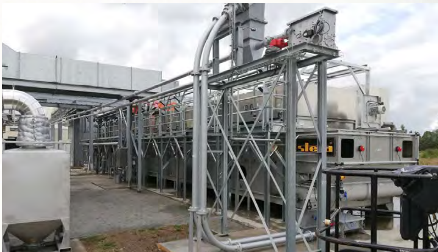
项目地：Ecoson, 比利时 | 型号：BTLU 1/3000-25 | 安装年份：2020 干燥物料：消化污泥 | 出料能力：约0.5吨/小时 | 降水区间：78% -15%湿度
