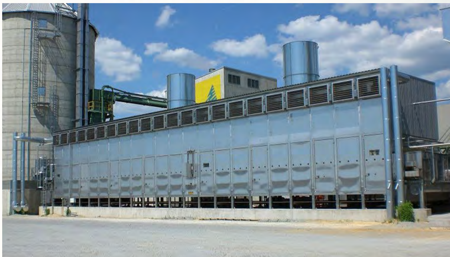
项目地：STA Skole II, 乌克兰 | 型号：BTL 1/3000-9 | 安装年份：2021 干燥物料：木屑 | 出料能力：约1.5吨/小时 | 降水区间：45% - 10%湿度
