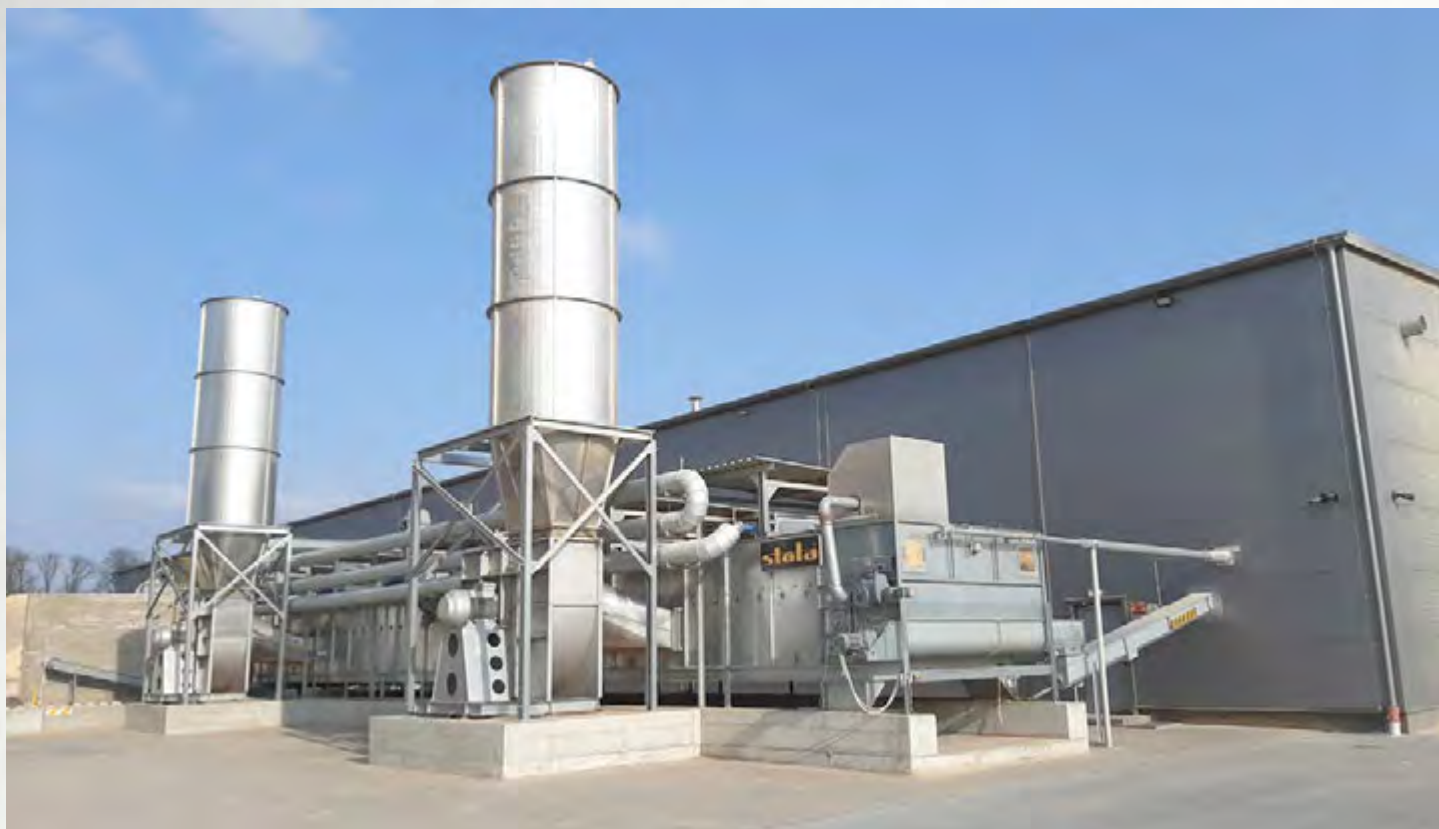
项目地：MMJ Sp. z.o.o., 波兰 | 型号：BTLU 1/3000-24 | 安装年份：2020 干燥物料：木屑 | 出料能力：约3.5吨/小时 | 降水区间：50% - 10%湿度
