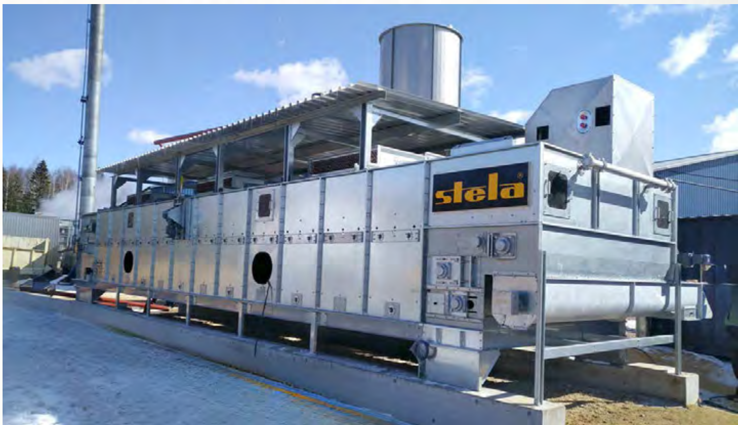
项目地：z/s Luseni, 拉脱维亚 | 型号：BTL 1/3000-12 | 安装年份：2022 干燥物料：木屑 | 出料能力：约1.4吨/小时 | 降水区间：55% - 10%湿度
