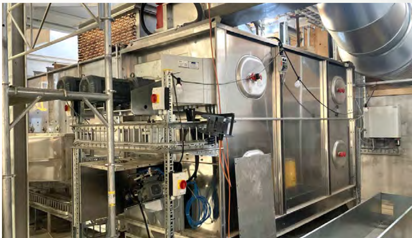
项目地: Optisol, 瑞典 | 型号: BTL 1/3000-10 | 安装年份: 2021 干燥物料: 木屑鸡粪混料 | 出料能力: 约2.3吨/小时 | 降水区间: 30% - 10%湿度
