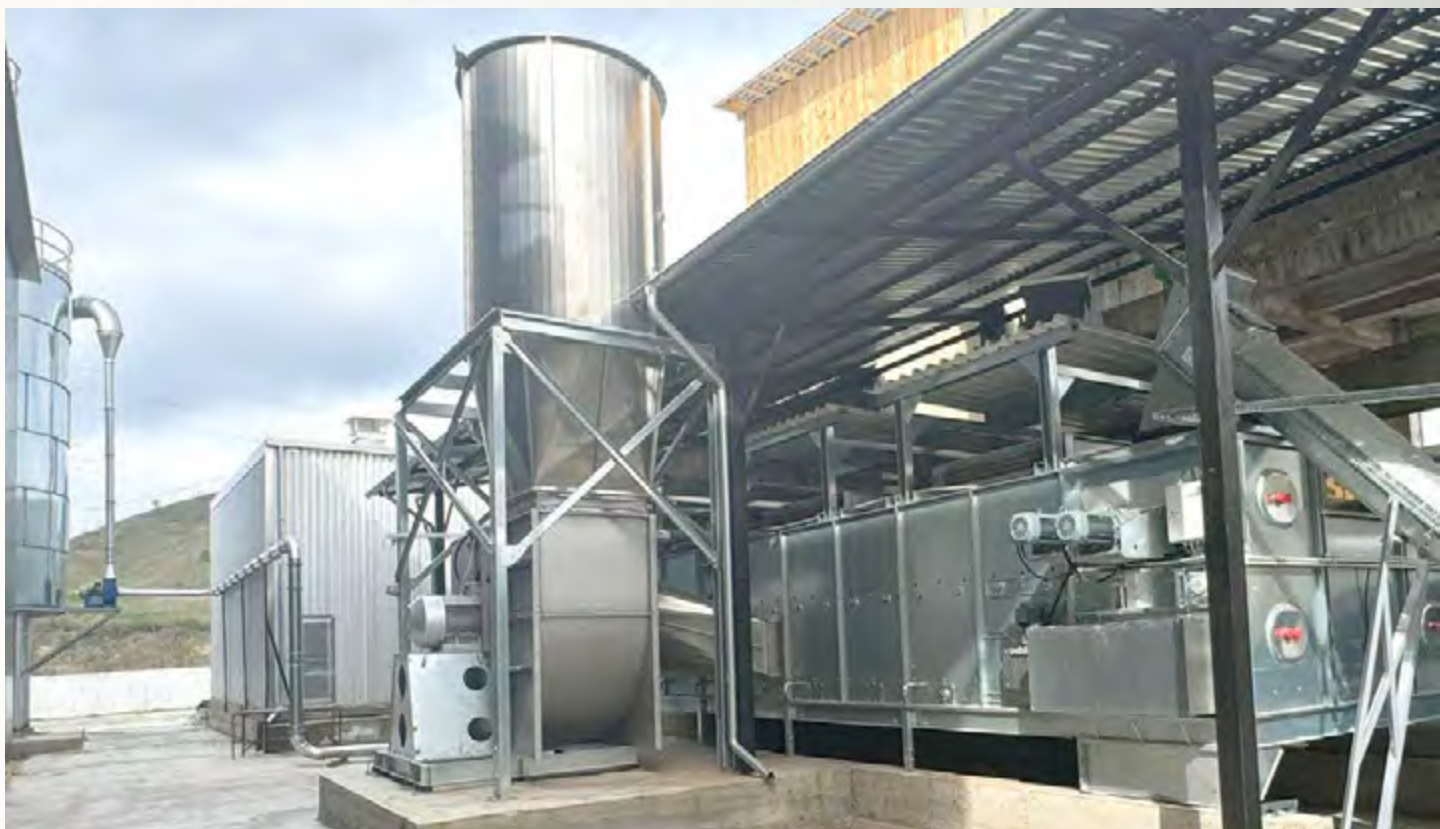
项目地：Molidul Impex S.R.L., 罗马尼亚 | 型号：BTL 1/3000-12 | 安装年份：2023 干燥物料：木屑 | 出料能力：约3.2吨/小时 | 降水区间：45% - 10%湿度
