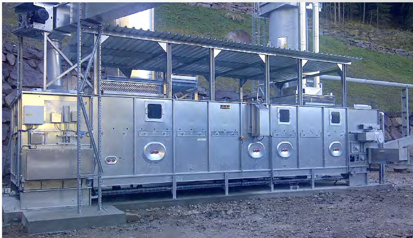
项目地：Bio Energy GmbH, 意大利 | 型号：BTL 1/3000-8 | 安装年份：2014 干燥物料：木屑 | 出料能力：约1.7吨/小时 | 降水区间：40% - 10%湿度
