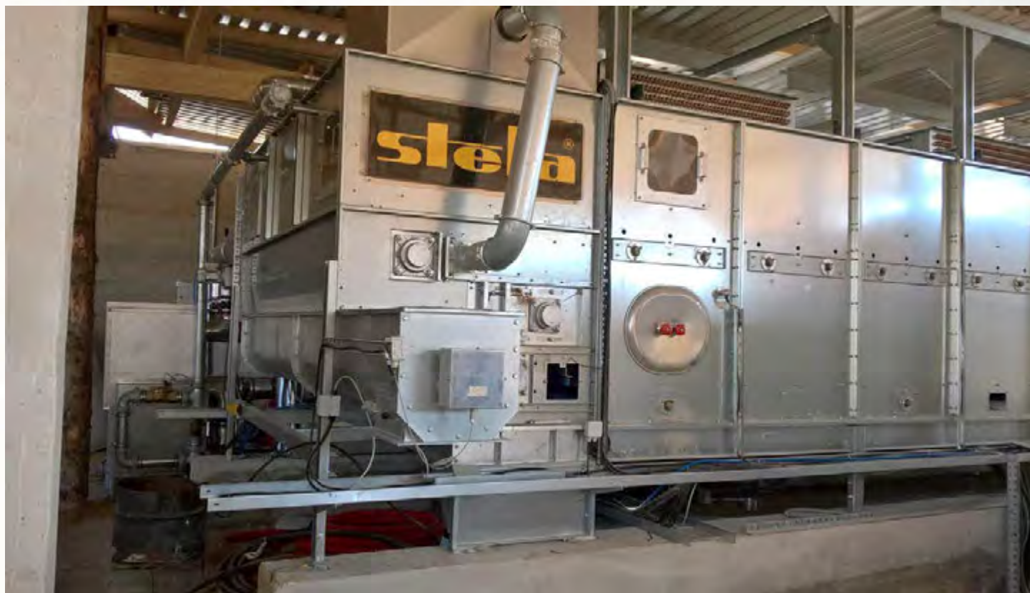
项目地：Pergament d.o.o., 克罗地亚 | 型号：BTL 1/3000-14 | 安装年份：2016 干燥物料：木片 | 出料能力：约2.5吨/小时 | 降水区间：40% - 10%湿度
