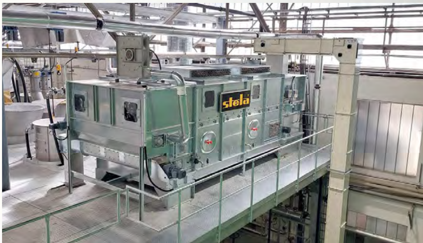
项目地：Akdeniz Chemson Additives AG, 奥地利 | 型号：BTL 1/2000-4 | 安装年份：2023 干燥物料：塑料颗粒 | 出料能力：约2.27吨/小时 | 降水区间：10% - 1%湿度
