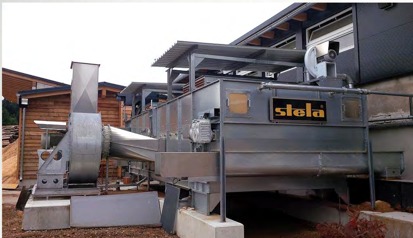
项目地: Holz Bauer KG, 奥地利 | 型号: BTL 1/3000-7 | 安装年份: 2013 干燥物料: 木屑 | 出料能力: 约0.8吨/小时 | 降水区间: 50% - 10%湿度
