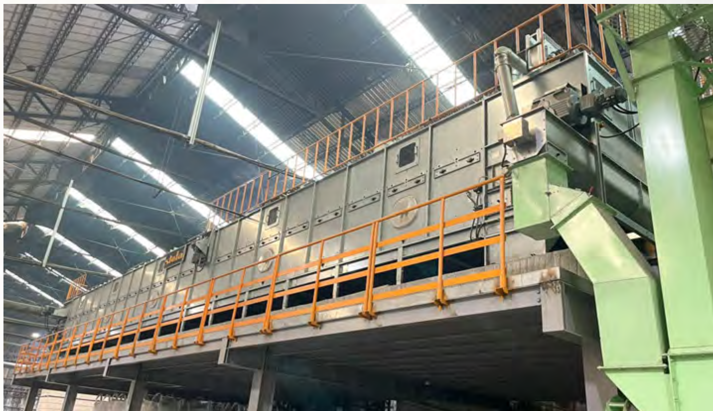
项目地：元鸿发展, 台湾 | 型号：BTL 1/3000-21 | 安装年份：2020 干燥物料：木片 | 出料能力：约3.65吨/小时 | 降水区间：56% - 10%湿度
