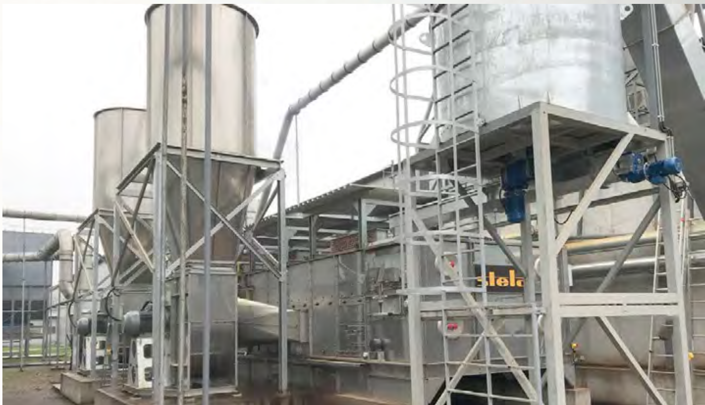
项目地：Tayfun Plus, 乌克兰 | 型号：BTL 1/3000-12 | 安装年份：2022 干燥物料：橡木屑 | 出料能力：约2.1吨/小时 | 降水区间：45% - 10%湿度
